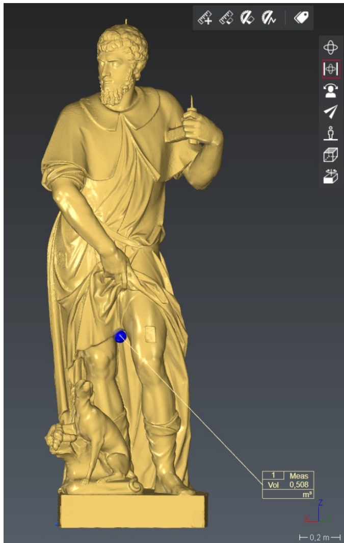
Figura 35 – Modello tridimensionale nell'interfaccia di calcolo di Faro SCENE
