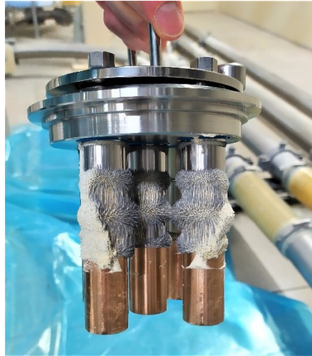
Fig. 6.8: Sistemi magnetici EHEDG senza camicia dopo il passaggio del materiale
