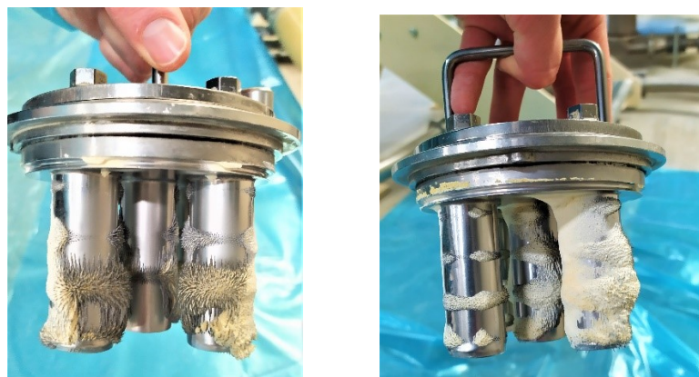
Fig. 6.7: Sistemi magnetici EHEDG con camicia dopo il passaggio del materiale
