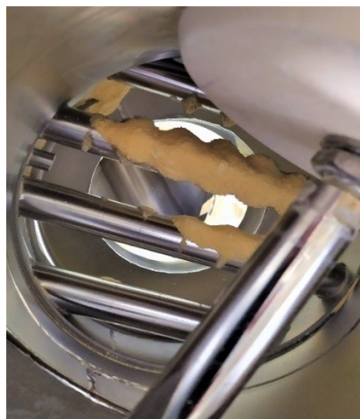
Fig.6.9: Materiale accumulato al di sopra della griglia magnetica
