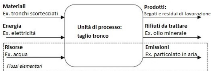
Figura 6. Esempio di unità di processo con flussi elementari di input e output. Gli input possono essere di massa (materiali), energia e risorse a cui corrispondono output di massa (prodotto), rifiuti ed emissioni, (Hauschild et al., 2018 adattata).
