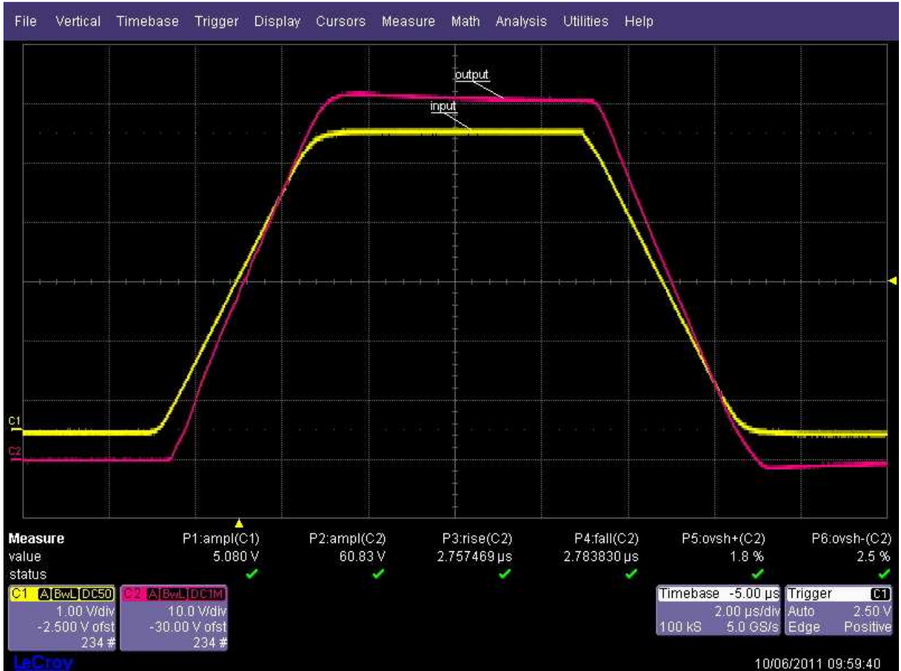
fig. 59: rampa 0-60V a 20\text{V}/\mu\text{s} , su carico leggero ( 100\Omega ).
