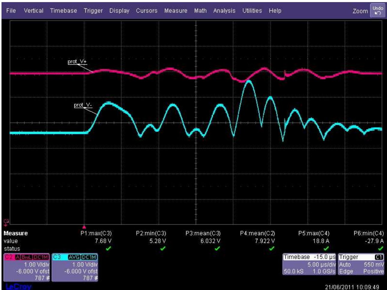
fig. 50: identiche condizioni della misura precedente, qui è evidenziato il rapporto tra il segnale presentato al circuito di protezione (in azzurro, lo stesso dell'immagine precedente) e la soglia di commutazione (in rosso). Il livello del segnale di corrente è tale da far quasi scattare la protezione, in questo specifico caso: riducendo il tempo di salita del segnale a 2\mu s, la protezione scatta correttamente dopo alcuni cicli.
