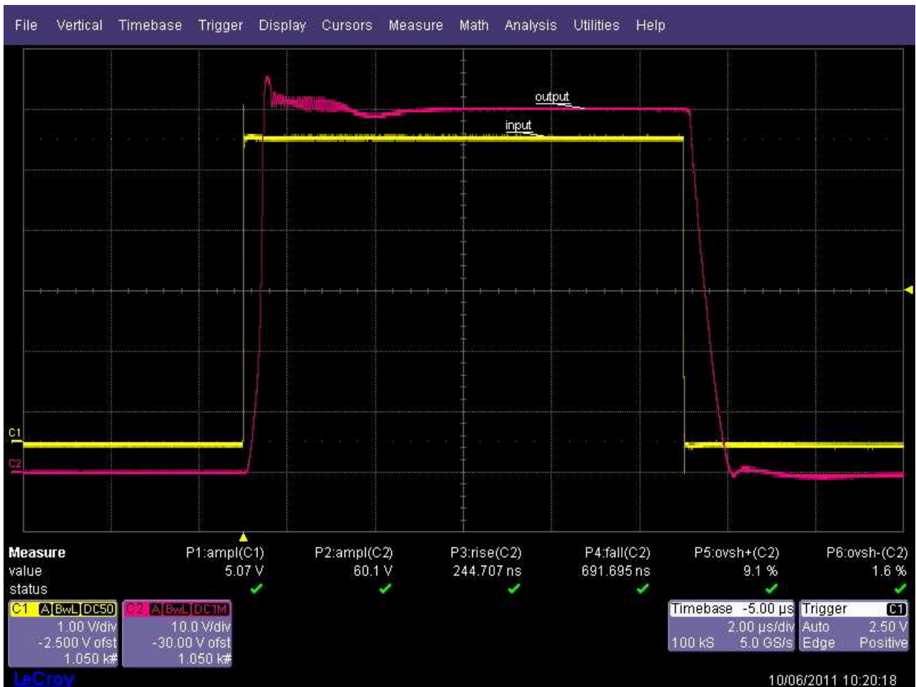
fig. 65: prestazioni intrinseche dell'amplificatore (generatore con tempo di salita pari a 5ns), carico 2.4\Omega (25Apk). Si noti la forte differenza nella risposta al gradino ai grandi segnali tra fronte positivo e fronte negativo; mentre il secondo manifesta una sostanziale pulizia e stabilità, il fronte di salita (corrispondente all'accensione dei 3 N-MOSFET) ha una sovraelongazione indice di un margine di fase non elevato.
