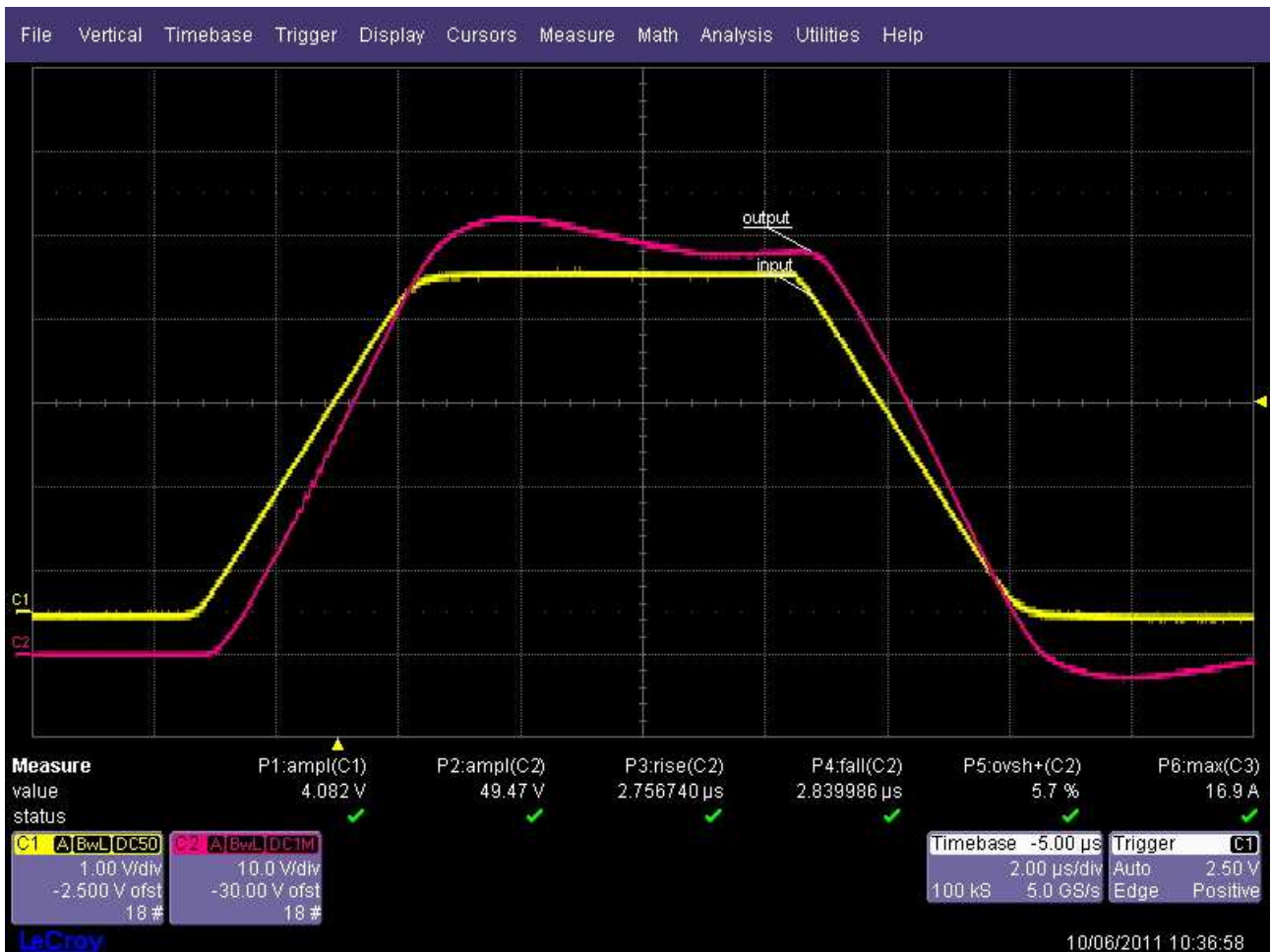
fig. 64: l'effetto di un condensatore di carico elettrolitico ( 1\mu\text{F} 50\text{V} - la tensione sul carico è stata ridotta). Si noti come l'elevata ESR smorza la risonanza e riduca considerevolmente il picco di corrente ( 16.9\text{A} ).
