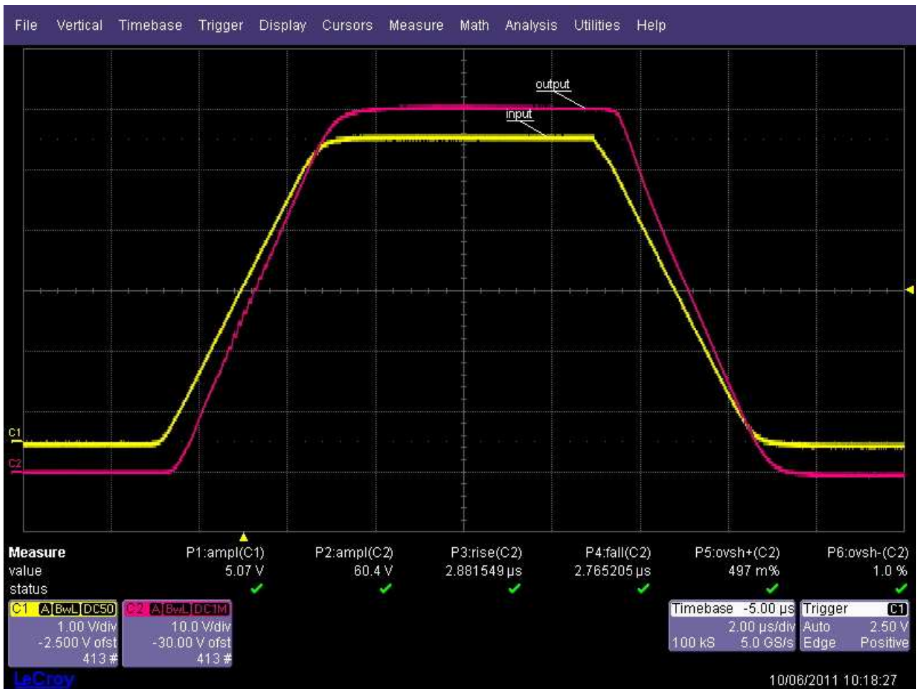
fig. 61: rampa 0-60V a 20V/μs, su carico 2.4Ω (25Apk).
