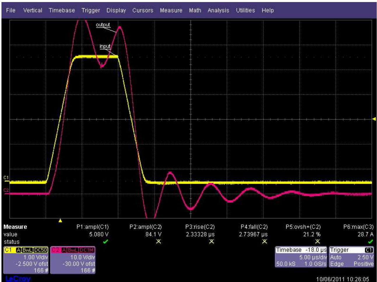
fig. 62: rampa 0-60V a 20V/μs, su carico 12Ω || 1μF. La tensione sul carico è misurata direttamente su un terminale del condensatore, quindi risente dell'effetto risonante della capacità stessa e dell'induttanza del cavo di collegamento, oltre all'impedenza d'uscita dell'amplificatore. Da altre misure effettuate, risulta che alle frequenze tipiche di oscillazione queste due grandezze induttive sono di circa 300nH per l'amplificatore e 500nH per il cavo.
