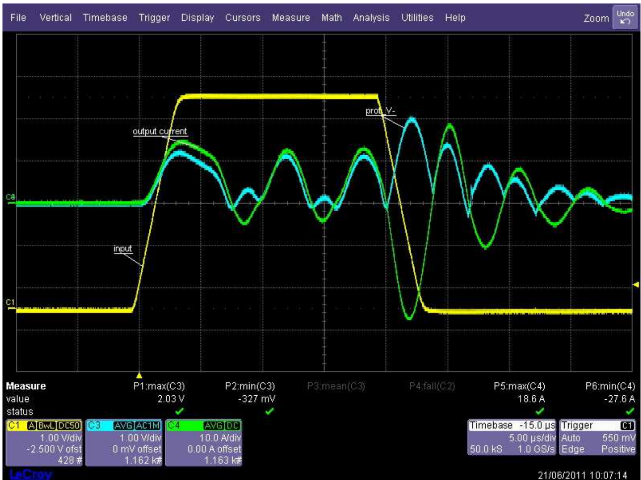
fig. 49: rampa 0-60V, 3 \mu s fronte, carico 10 \Omega || 1 \mu F a bassa ESR. La traccia gialla è il segnale d'ingresso all'amplificatore, quella verde è la corrente di carico e quella azzurra è il segnale fornito dal trasformatore di corrente, a seguito della rettifica effettuata dal ponte a diodi Schottky.
