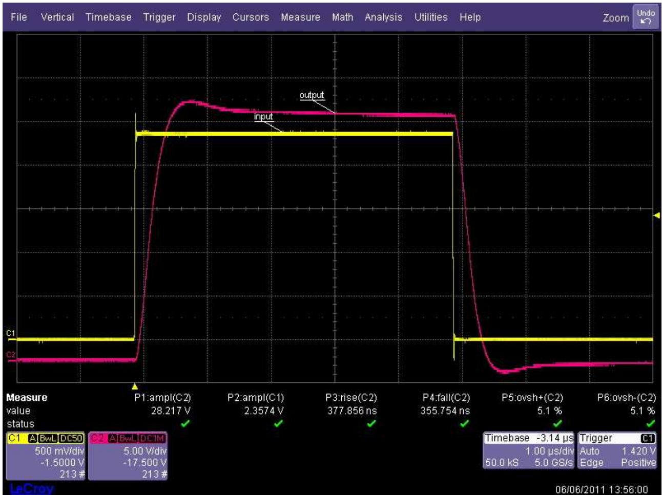
fig. 23: misura di stabilità e velocità dell'amplificatore a fronte di una riduzione della tensione di alimentazione.
