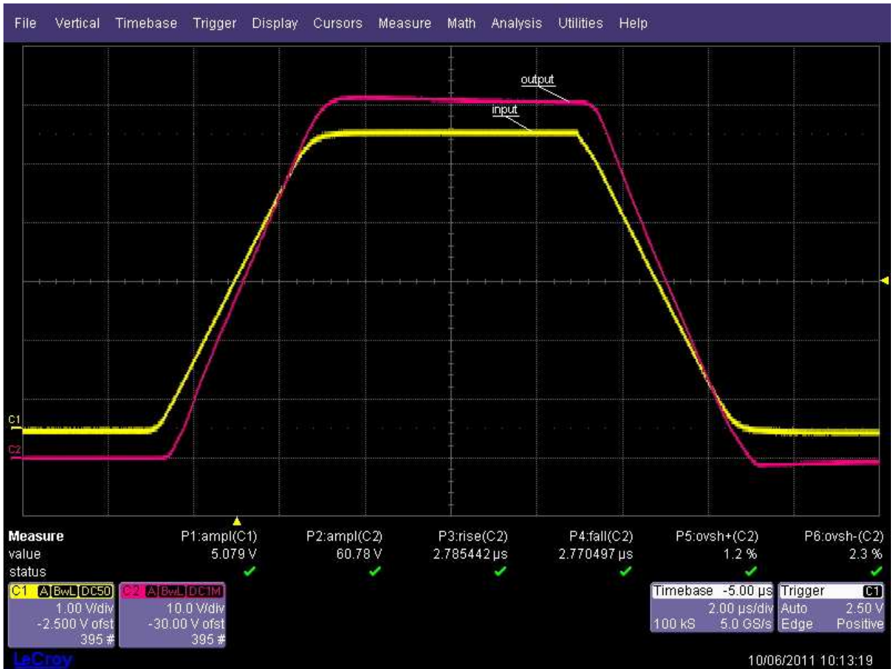
fig. 60: rampa 0-60V a 20V/μs, su carico 12Ω (5Apk).
