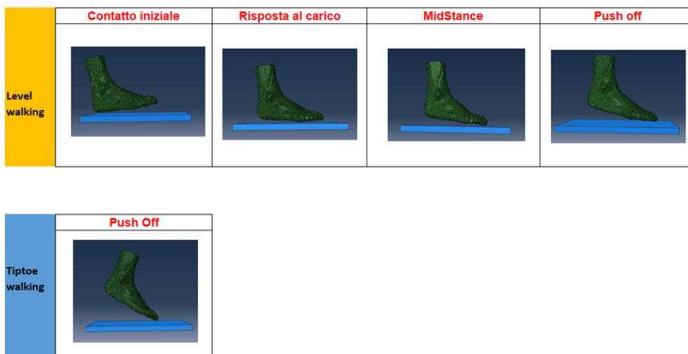
Figura 57: Modelli Abaqus piede-pedana generati a partire da 3T MR in scarico e simulati nelle fasi di contatto iniziale, risposta al carico, midstance e push off della level walking e nella fase di push off della tip toe walking.
