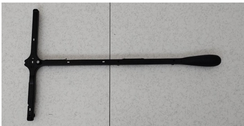
Figura 33: Esempi di configurazione delle wand durante la calibrazione statica, nelle quali i parametri delle telecamere vengono inizializzati.
