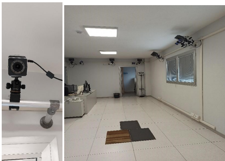
Figura 34: Sistema optoelettronico VICON (sinistra). Laboratorio di Analisi del Movimento dell'Università degli Studi di Padova (destra).
