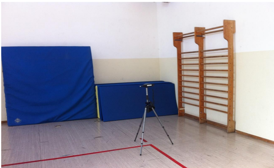
Figura A1. 2 – posizionamento del microfono durante in montaggio della strumentazione.
