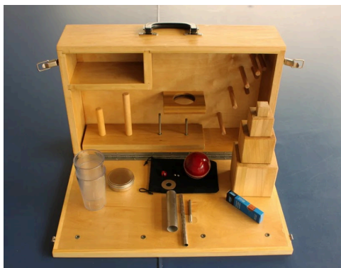
Figura 4.2.4: Kit strumentale standardizzato utilizzato per l'esecuzione dell' Action Research Arm Test (ARAT) con evidenza degli oggetti di differenti forme, dimensioni e pesi.
