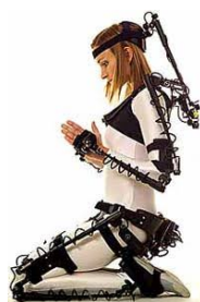
Figura 2.2.2: Sistema di tracciamento cinematico basato su esoscheletro meccanico META Motion Gypsy.
