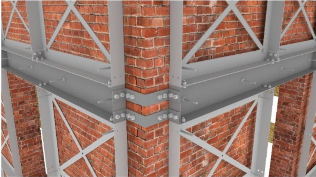
*Figura 17) Ancoraggio al cordolo (Progetto Sisma)*
