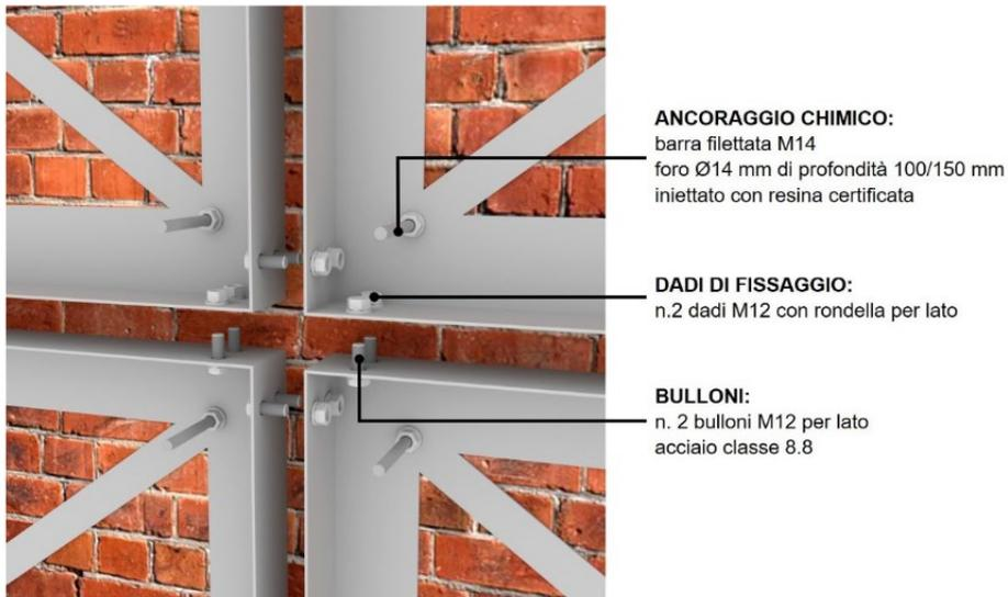
Figura 15) Ancoraggio aderente alla parete in muratura (Progetto Sisma)
