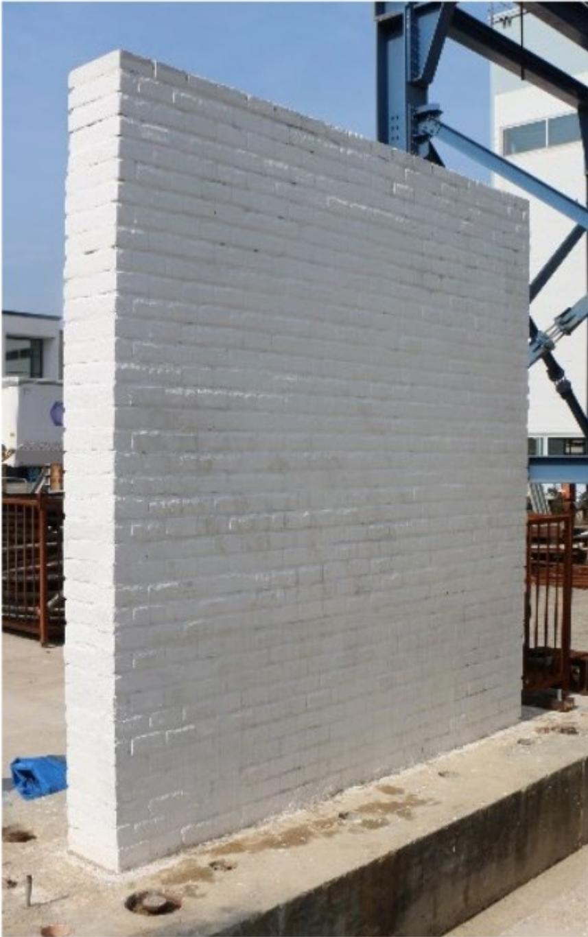
*Figura 19) Provino iniziale, composto da mattoni (Fondazione EUCENTRE)*
