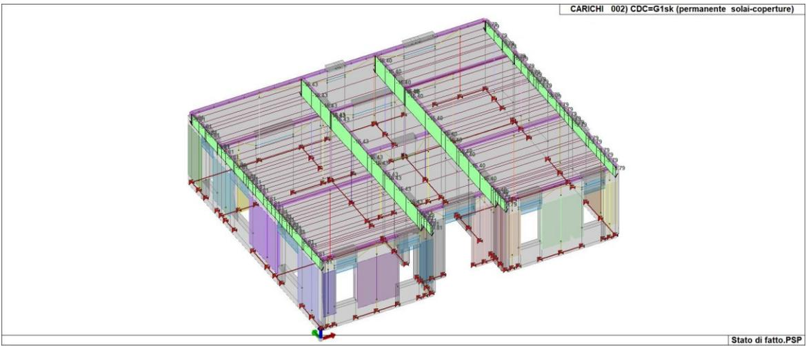
Figura 46) CDC=G1sk (permanente solai-coperture)
