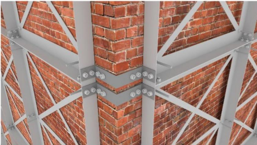
Figura 16) Ancoraggio angolare (Progetto Sisma)
