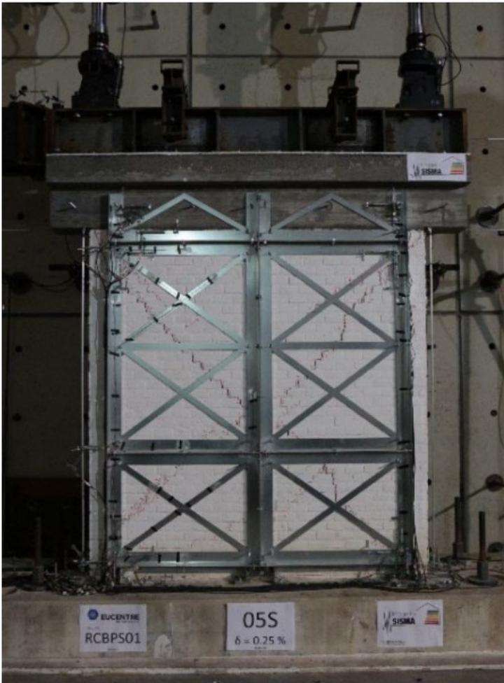
Figura 27) Provino rinforzato collassato a seguito della prova ciclica (Fondazione EUCENTRE)
