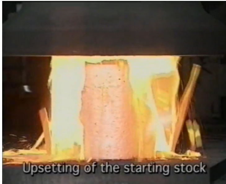
Figura 2.6: Foto che rappresenta il momento della perdita della “scaglia” durante il primo upsetting.
