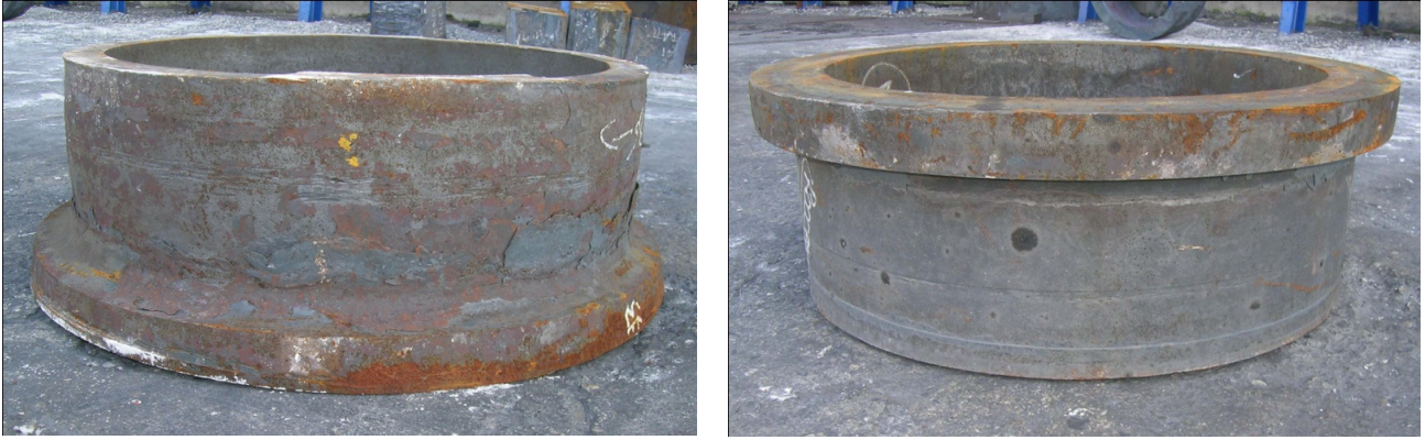
Figura 2.16: Foto del componente CH-10337 a laminazione ultimata (ma prima della sgrossatura finale).
