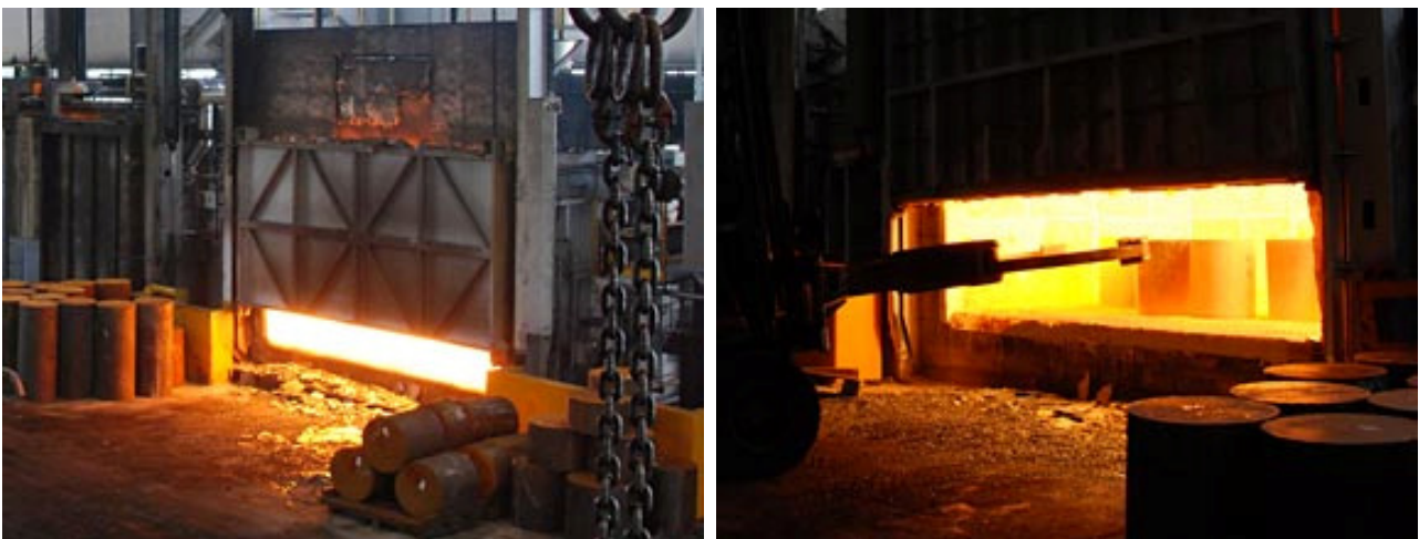
Figura 2.3: Il forno a metano presente in ASFO spa . Un carrello trilaterale di grosse dimensioni carica e scarica le billette dalla fornace (fonte [6]).
