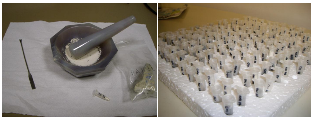
Figura 3.1 A sinistra: strumenti per la macinazione dei campioni di roccia: spatolina, mortaio con pestello, provetta, campione di roccia. A destra: i campioni polverizzati.
