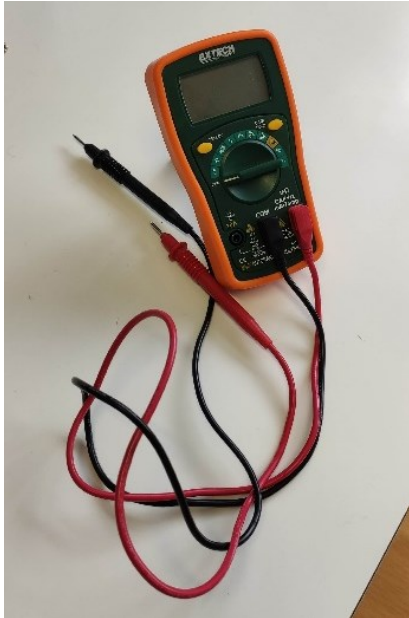
Figure 8 e 9) Strumentazione utilizzata per le misure di resistenza sui sensori: a sinistra tester portatile utilizzato per la valutazione preliminare della conducibilità delle tracce stampate (8), a destra multimetro digitale utilizzato per effettuare le misurazioni durante la caratterizzazione (9).
