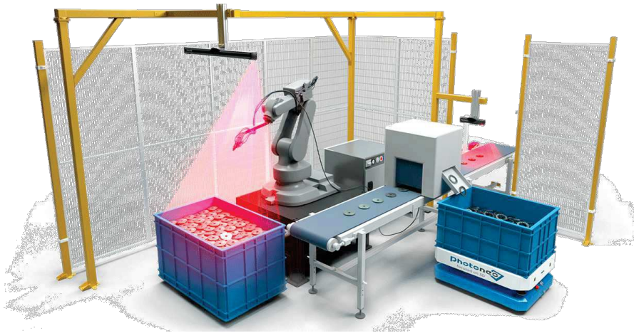
Figura 1.1: Esempio di una cella robotizzata per il bin picking (courtesy Yaskawa)
