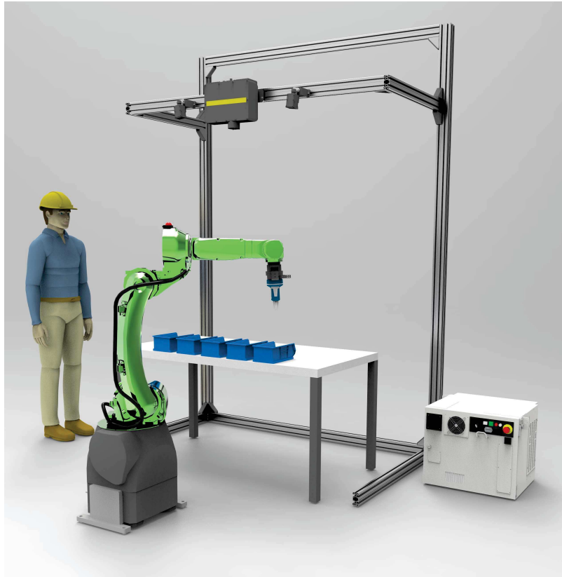
Figura 2.1: Cella robotizzata implementata
