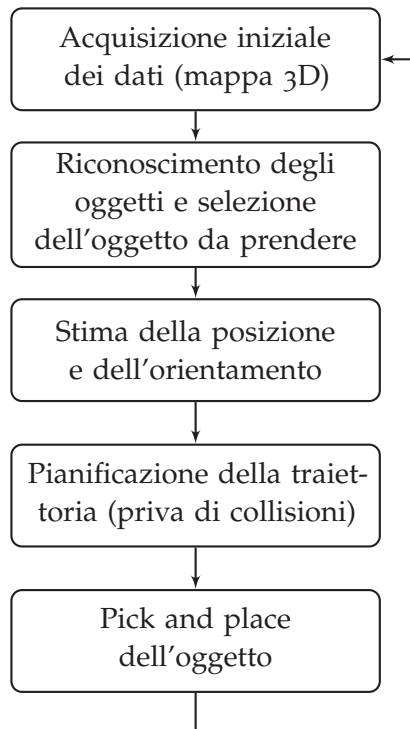
Figura 1.2: Flowchart del processo di bin picking
