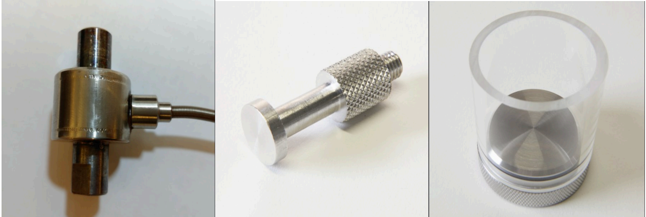
Figura 18: (a) A sinistra, cella di carico Biomomentum; (b) in centro, indentatore piatto; (c) a destra camera piana.
