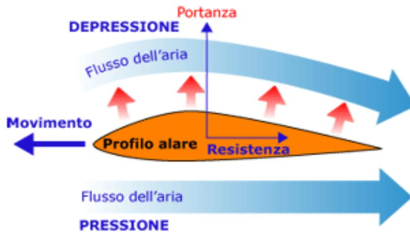
**Figura 2.5** *Profilo alare e forze aerodinamiche*
