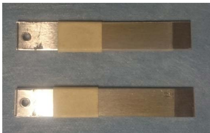
Figura 6.10: Depositi su barrette da 2mm
