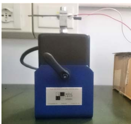
Figura 9.4: Shaker elettrodinamico MODAL SHOP 2007E
