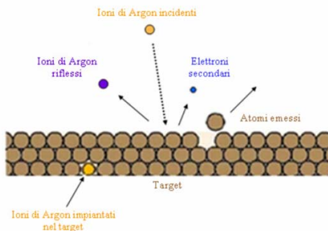
Figura 4.1: Fenomeno dello sputtering
