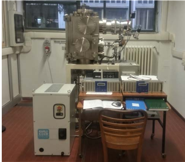
Figura 6.4: Configurazione completa del sistema magnetron di laboratorio
