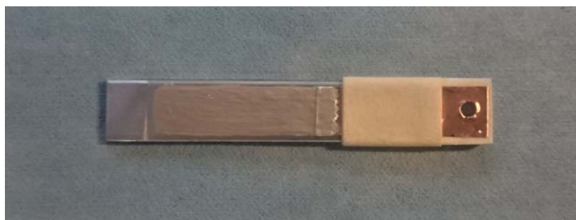
Figura 7.6: Lamina da 2mm del primo deposito con vernice conduttiva
