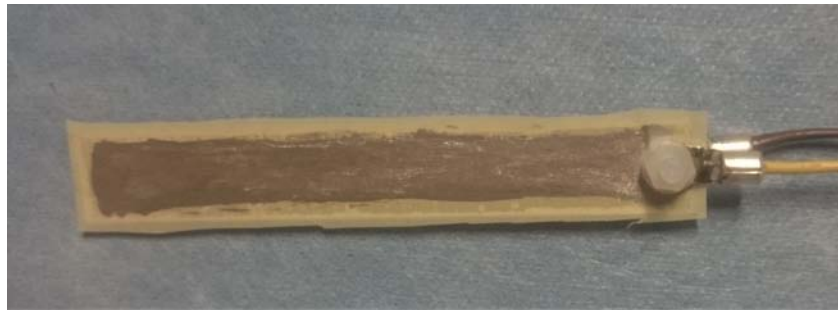
Figura 8.2: Lamina da 2mm con poliestere e vernice SCP
