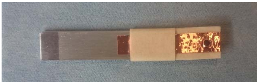
Figura 7.5: Barretta con copertura di nastro di carta sopra il rame
