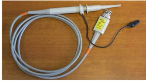
Figura 9.7: Sonda passiva di tensione YOKOGAWA 700998
