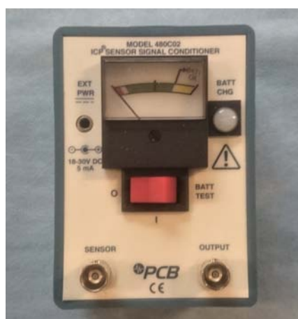
Figura 9.5: Condizionatore di segnale PCB 480C02
