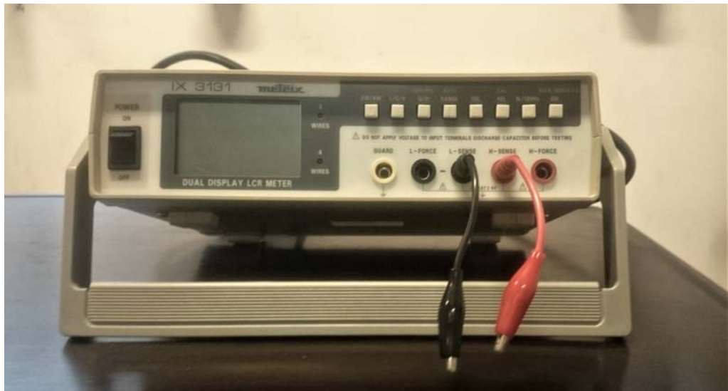
Figura 8.5: Ponte di misura RLC Metrix IX 3131
