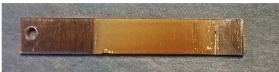
Figura 6.12: Deposito su barretta da 2mm
