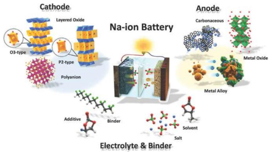
Figura 15: Schema compositivo per batteria agli ioni di sodio (Wikimedia Commons, 2016)
