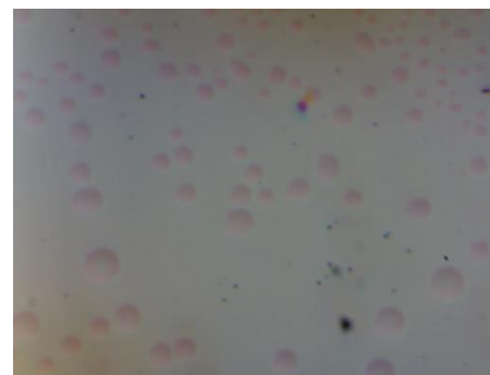
Figura 21: immagine delle “bolle” presenti nel campione 936 a 400°C osservata al microscopio ottico (50x)
