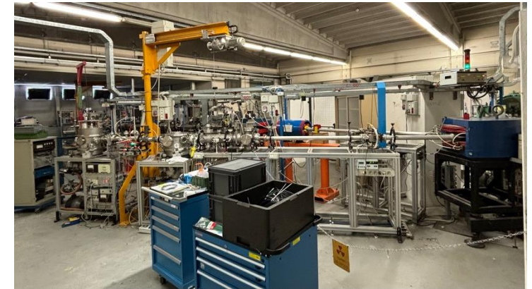
Figura 1: Fotografia dell' impianto di accelerazione di particelle 'AN2000' utilizzato per caratterizzare i campioni
