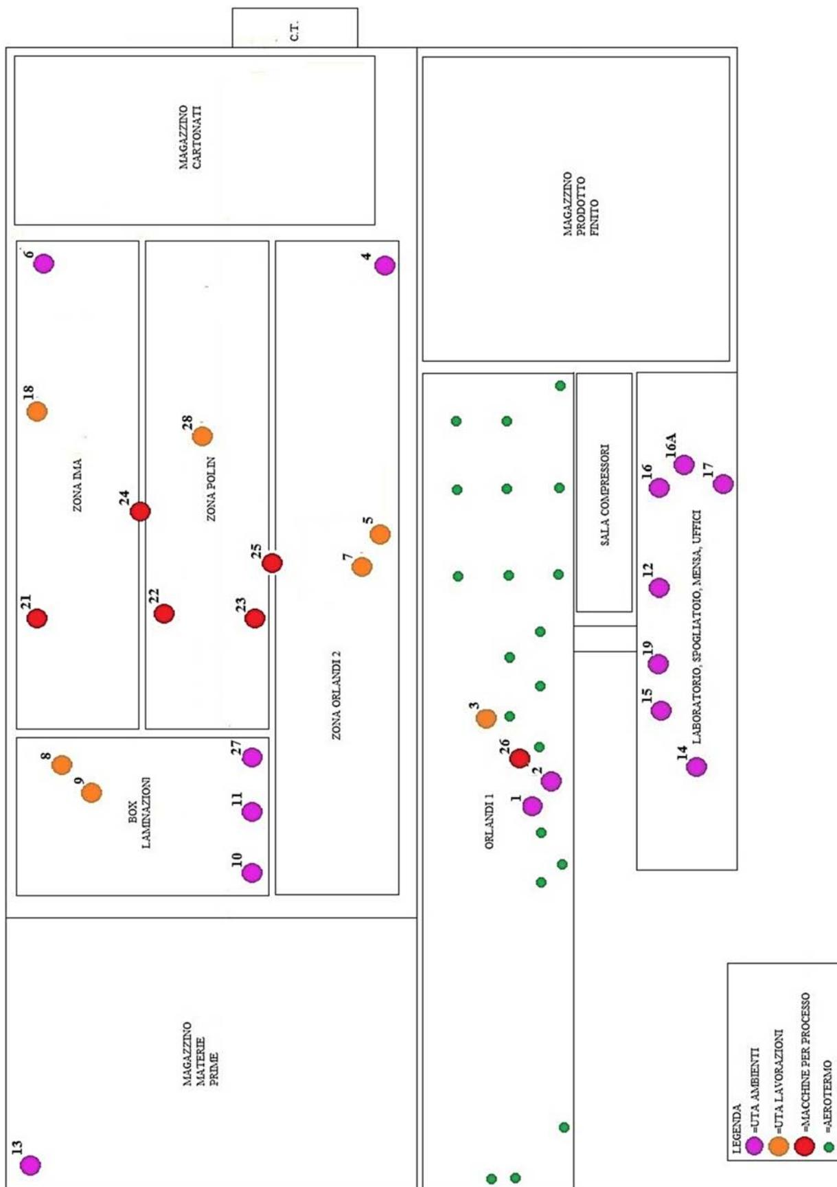
FIGURA 20 – NUMERAZIONE E POSIZIONAMENTO DEI CARICHI TERMICI ALL'INTERNO DELLO STABILIMENTO
