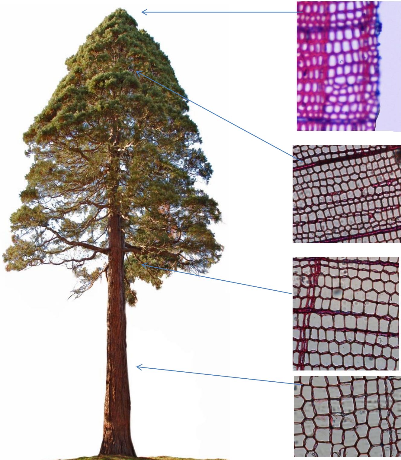
Figura 1.1 Variazione del diametro delle tracheidi del legno primaticcio dell'ultimo anello di accrescimento. Sezioni trasversali, ingrandimento 500x (dall'alto verso il basso rispettivamente: 94,8, 90, 60, 20 m).
