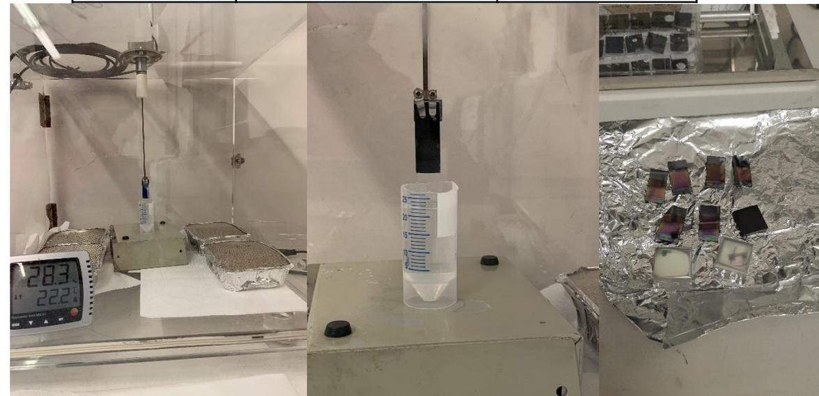
SPESSORE OTTIMIZZATO REGOLANDO LA VELOCITA' DI RITIRO DURANTE LA FASE DI ESTRAZIONE NEL DIP COATING
