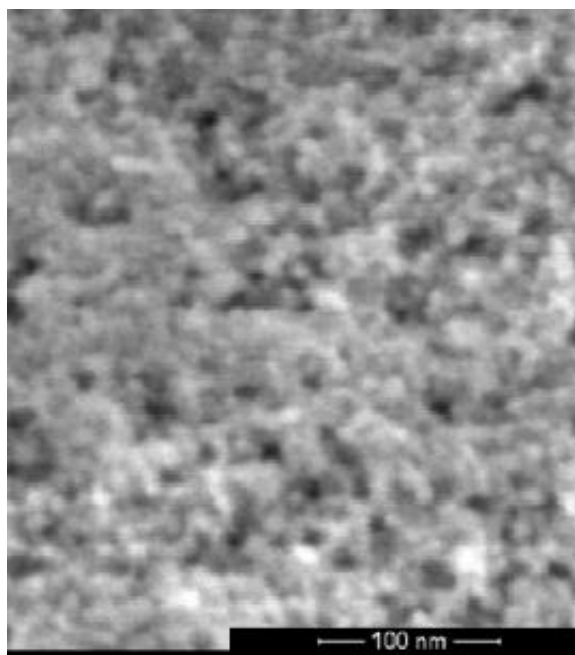
Fig. 4.16: micrografia SEM del film sottile di \text{ZnO} trattato termicamente a 100^\circ\text{C} (scala: 100 nm).
