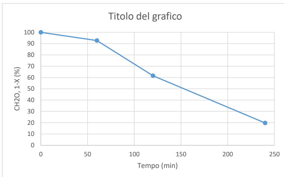
Figura 5.8 Andamento nel tempo della percentuale di formaldeide residua per la membrana PAN-TiO 2 P25-GO elettrofilata "in massa".
