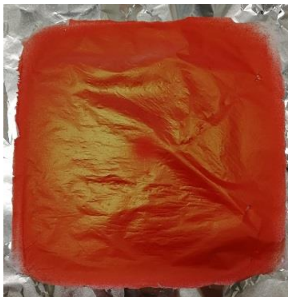
Figura 4.26 Fotografia della membrana in PVP – MEH-PPV realizzata tramite electrospraying su un foglio di alluminio.
