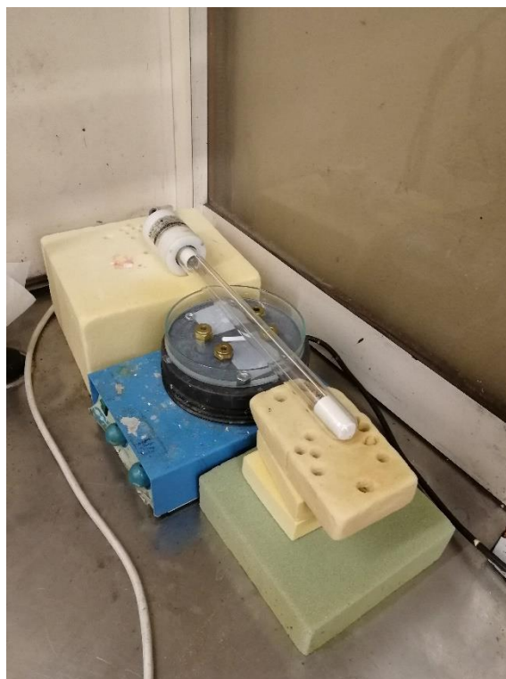
Figura 5.1 Fotografia del set-up utilizzato per svolgere i test fotocatalitici di degradazione della formaldeide.
