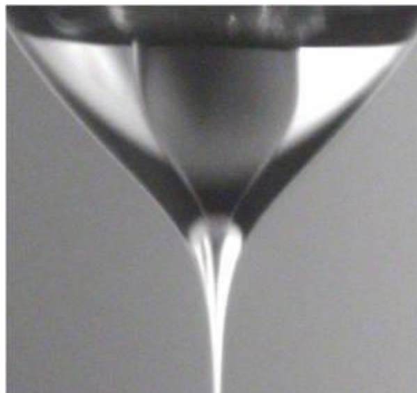
Figura 2.6 formazione del cono di Taylor nel processo di electrospinning coassiale.
