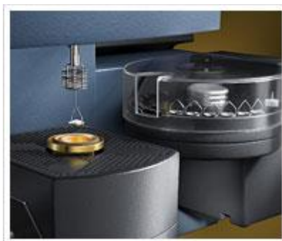
Figura 3.13 Particolare dello strumento per la TGA.
