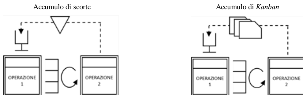
Figura 5.12 - Differenze nel funzionamento tra Signal Kanban e Batch Kanban
