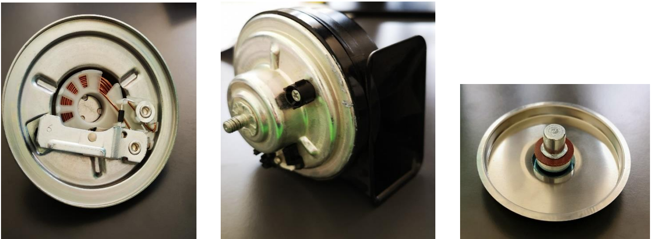
Figura 3.1 - Da sinistra a destra: motore aperto avvisatore con meccanismo elettro-meccanico; motore chiuso avvisatore; membrana con nucleo ferromagnetico e rondella in bachelite
