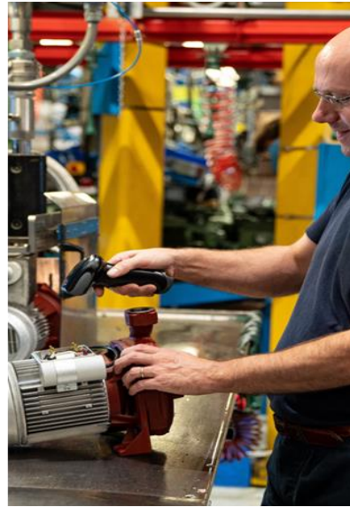
Figura 2.9 Scansione del codice a barre di un prodotto prima del suo collaudo [46]
