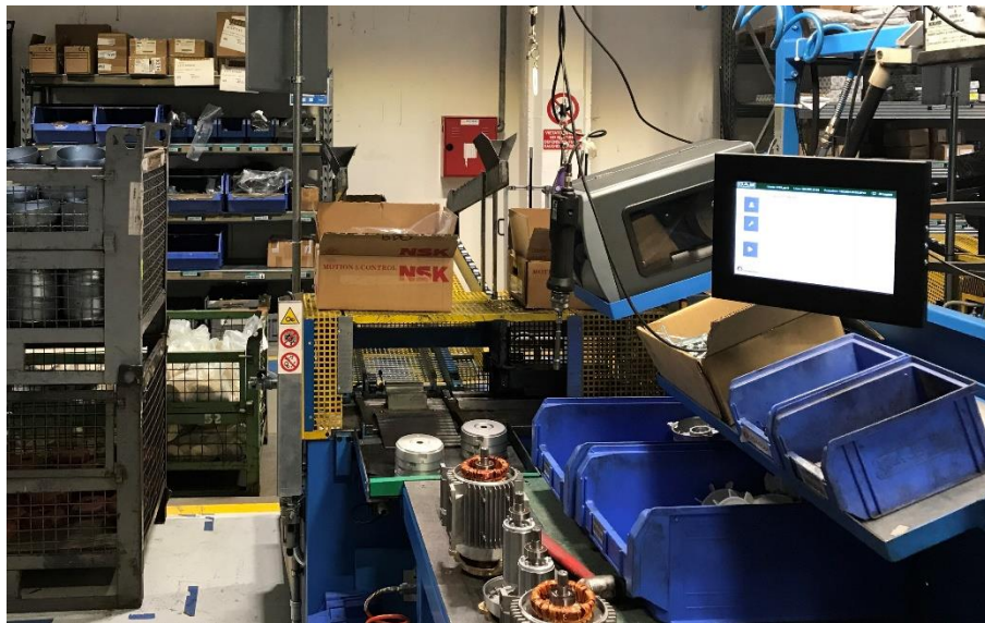
Figura 2.8 Prima stazione con stampante e tablet per il lancio della produzione
