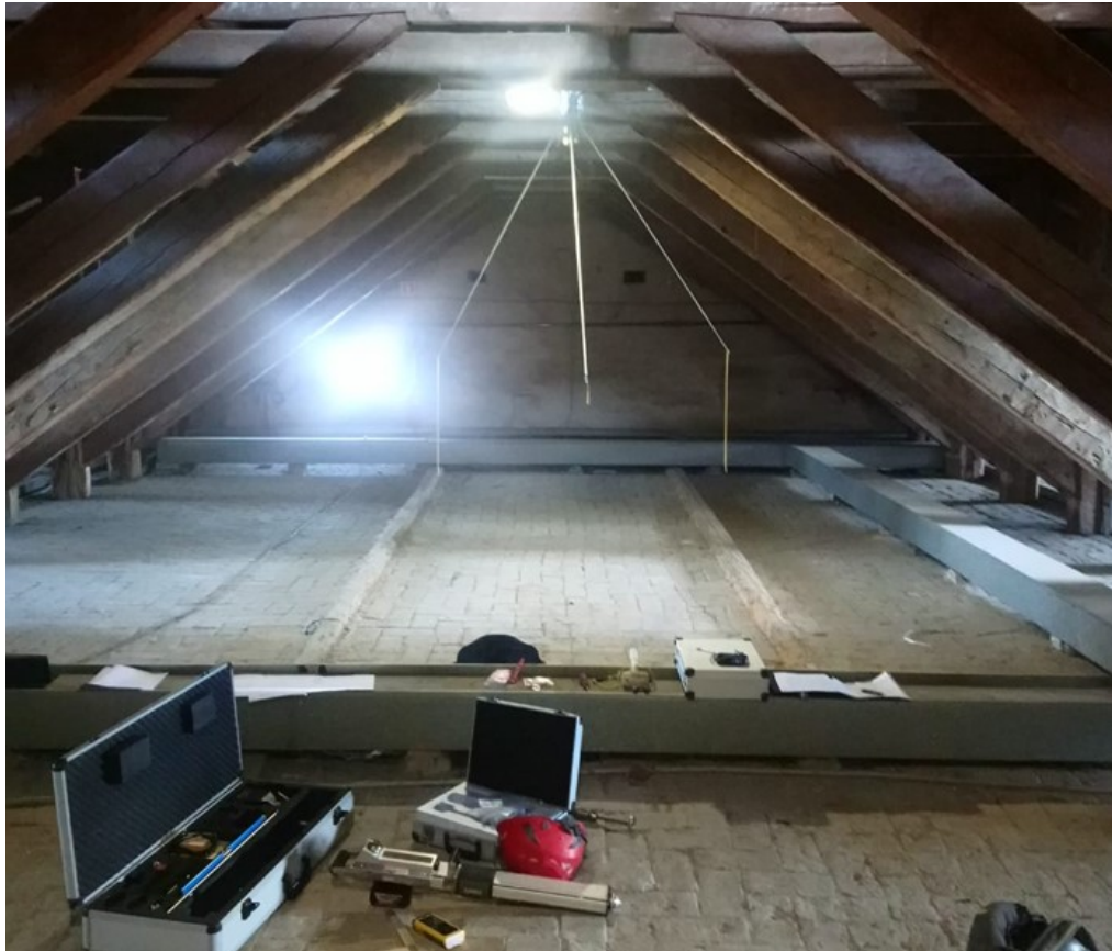
Fig. 4.40: Strumentazione per prove con trapano resistografico IML RESI PD 400.
