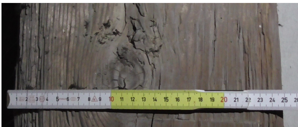
Fig. 3.9: Esempio di rilievo geometrico di un nodo su di un elemento di capriata.
