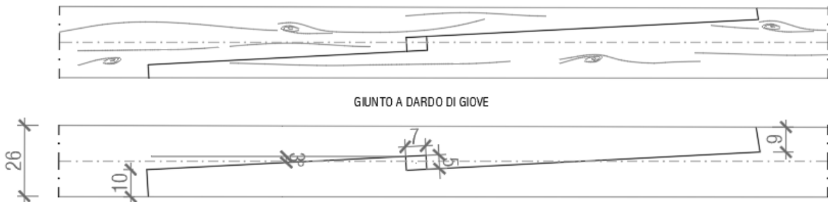
Fig. A.10: Capriata "Tipo B" - Rilievo geometrico del giunto a 'dardo di Giove'.
