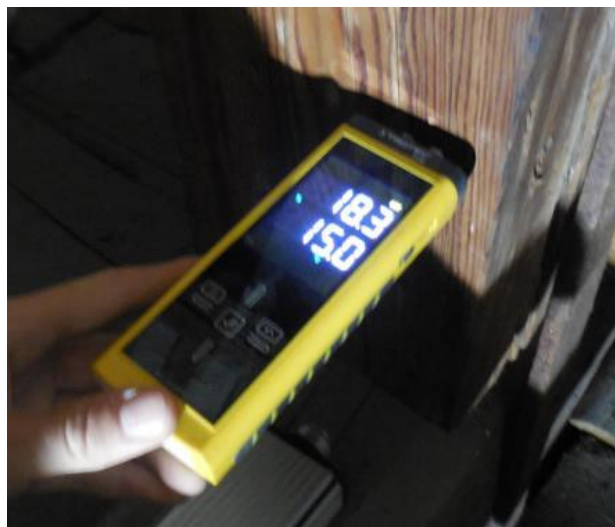
Fig. 4.38: Indagine con igrometro elettrico a resistenza Trotec T510.
