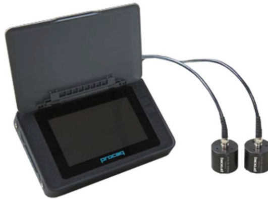
Fig. 3.7: Strumentazione per prove ultrasoniche tipo Proceq Pundit PL-200 (Fonte: proceq.com).
