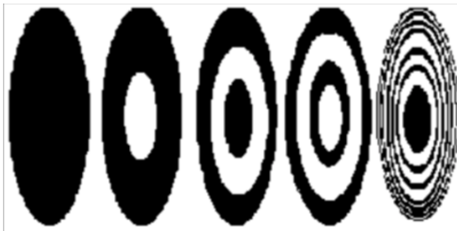
Figura 3: Frange di Haidinger. Da Dispense del Corso di Ottica Applicata [D'Onofrio, 2014].
