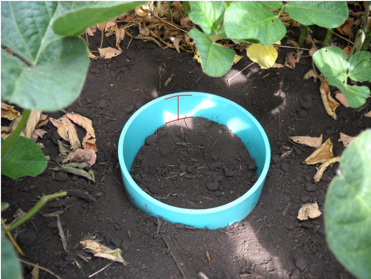
Foto 22: Installazione del collare in PVC in un interfila di soia. In rosso la misura dell'offset.
