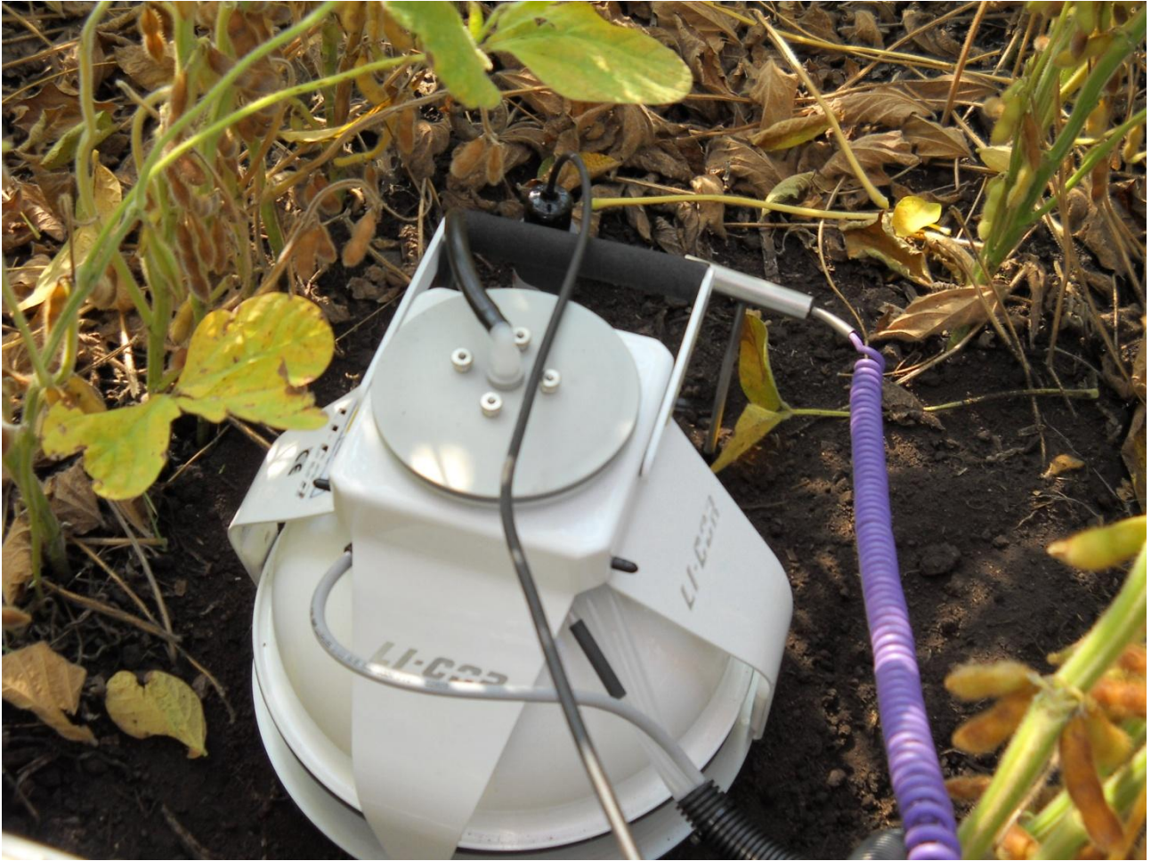
Foto 23: Camera e sensori di umidità e temperatura del terreno durante un ciclo di misura.
