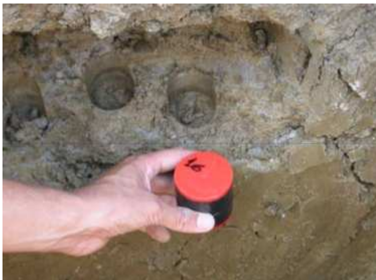
Figura 2.1: Raccolta di un campione di terreno per l'analisi dell'umidità con il metodo gravimetrico.
