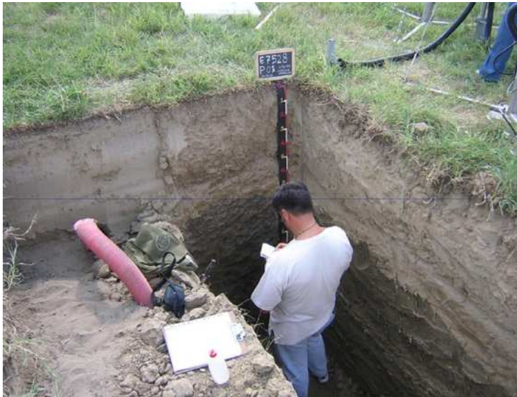
Figura 2.6: Misurazioni per il posizionamento delle sonde TDR.
