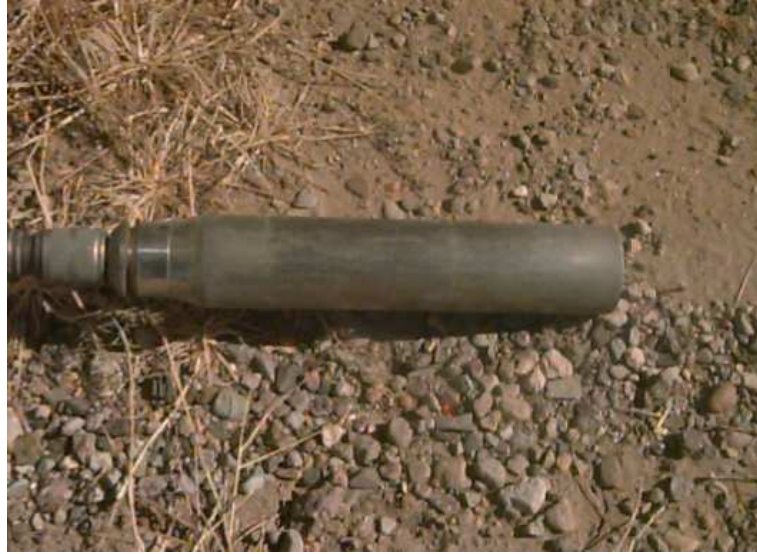
Figura 2.2: Sonda contenente la sorgente radioattiva.
