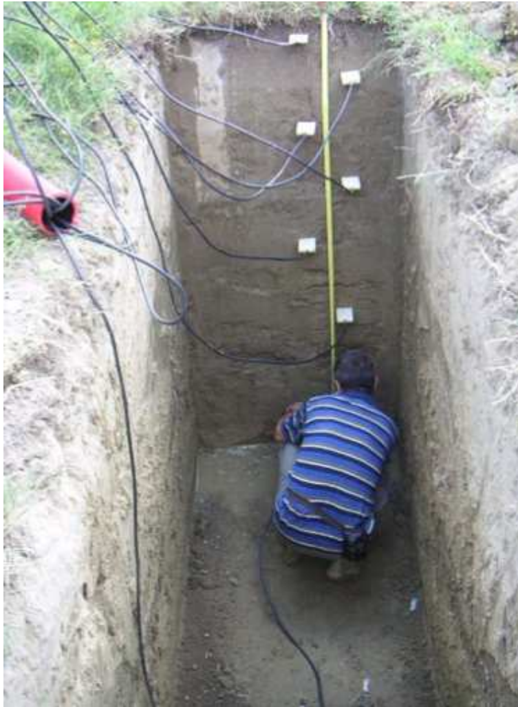
Figura 2.7: Posizioni delle sonde entro il terreno.
