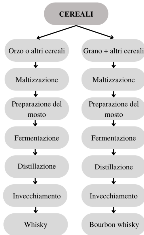
Grafico 1.2 Processo di distillazione base per cereali
