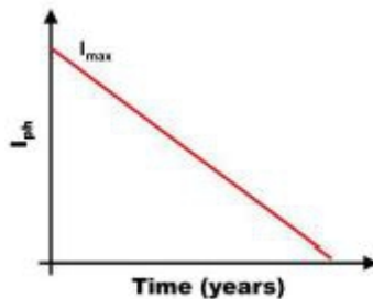
Illustrazione 24: Degrado dovuto alla doratura dell'incapsulante.
