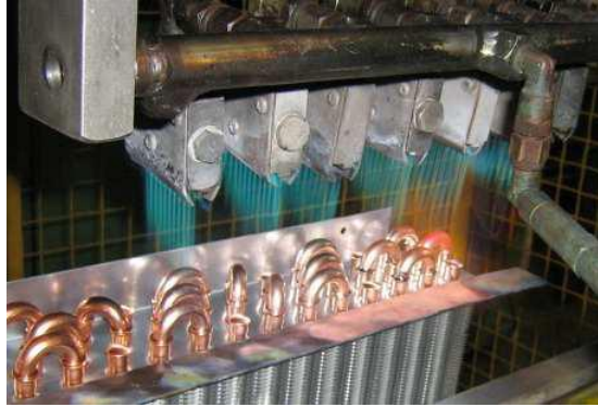
Figura 1.5: Operazione di saldobrasatura delle curve.
