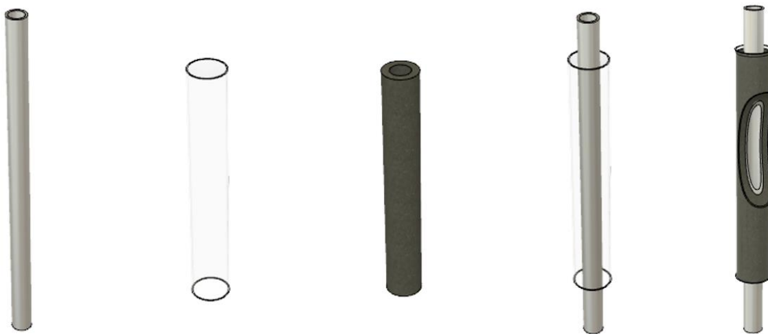
Fig. 5.1: Rappresentazione del modulo test, da sinistra: tubo in alluminio, tubo in Plexiglass, schiuma di alluminio, campione senza schiuma e campione con la schiuma (Fonte: elaborazione propria).
