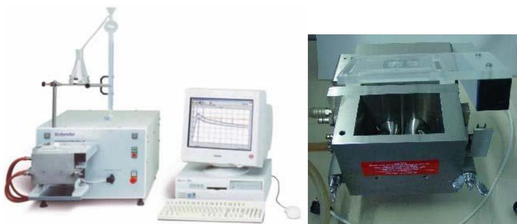
*Figura 10: Farinografo di Brabender (sinistra) e un dettaglio della cella impastatrice (destra).*
