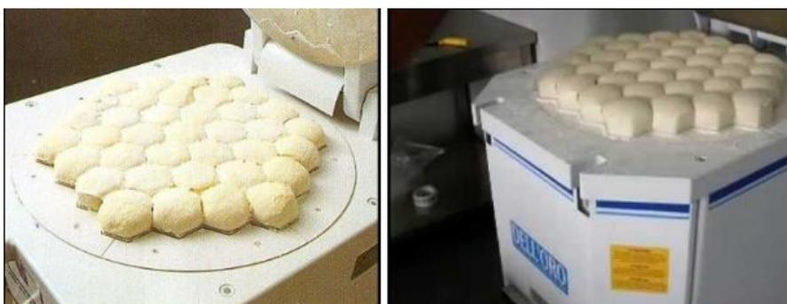
*Figura 24: Spezzatrici per la produzione di pane in pezzi di forma esagonale.*
