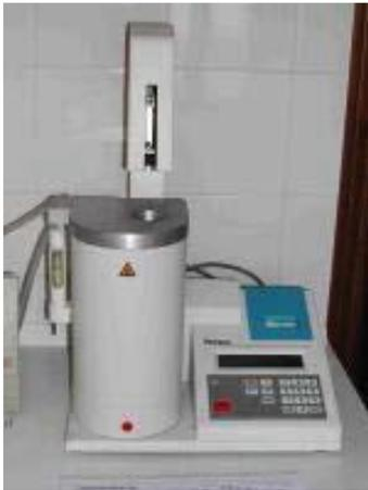
Figura 13: Strumento per misurare l'Indice di caduta.
