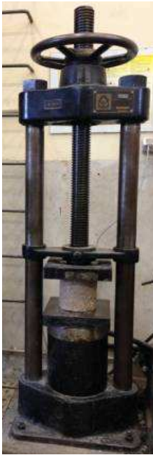
Fig. 66 – Pressa idraulica utilizzata per la rottura dei provini.
