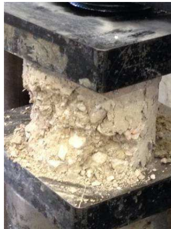
Fig. 68 – Rottura provino Auronzo.
