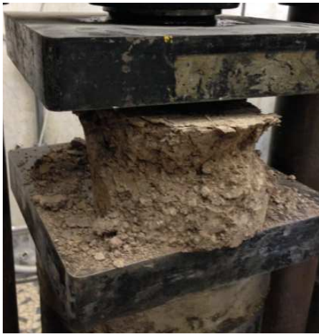
Fig. 67 - Rottura provino Lozzo.
