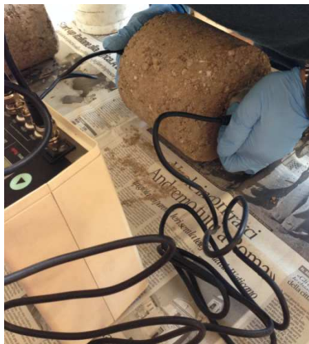
Fig. 65 – Misura con strumento ad ultrasuoni mediante trasmissione diretta
