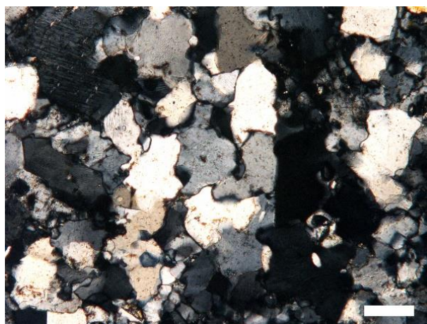
Figura 4.10 Immagine a nicol incrociati della matrice della roccia. Si osservano estinzioni dei cristalli a grana fine di quarzo con bordi granulari interlobati. Scala 100 \mu\text{m} .
