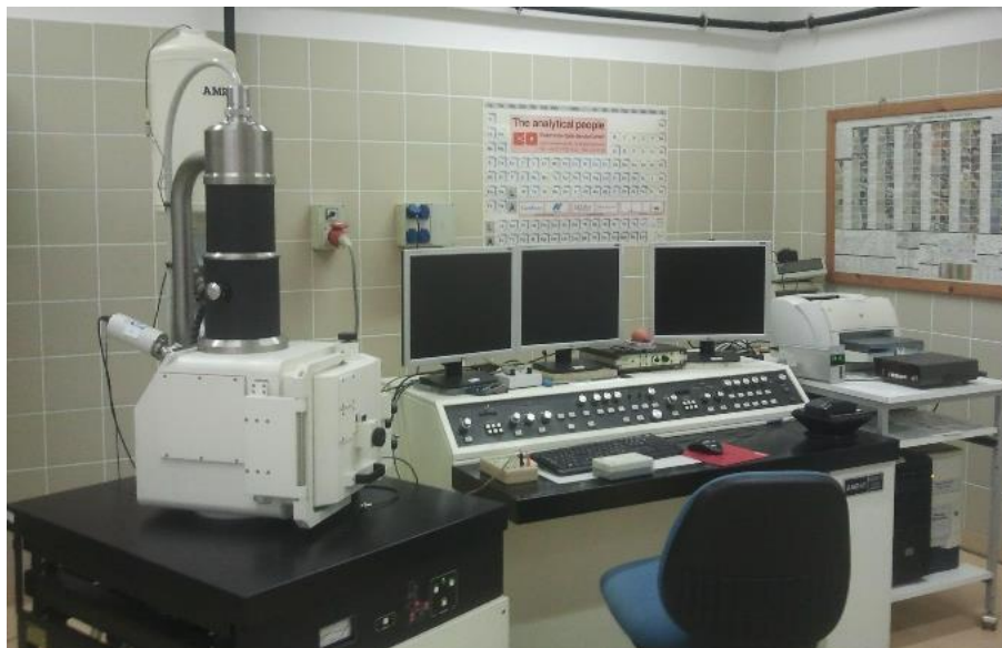
Figura 3.3 Microscopio elettronico a scansione (SEM) presso la Facoltà di Scienze all'Università di Budapest.
