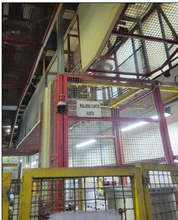
Fig. 3.2 – Discensore che preleva le ruote dal trasportatore aereo
