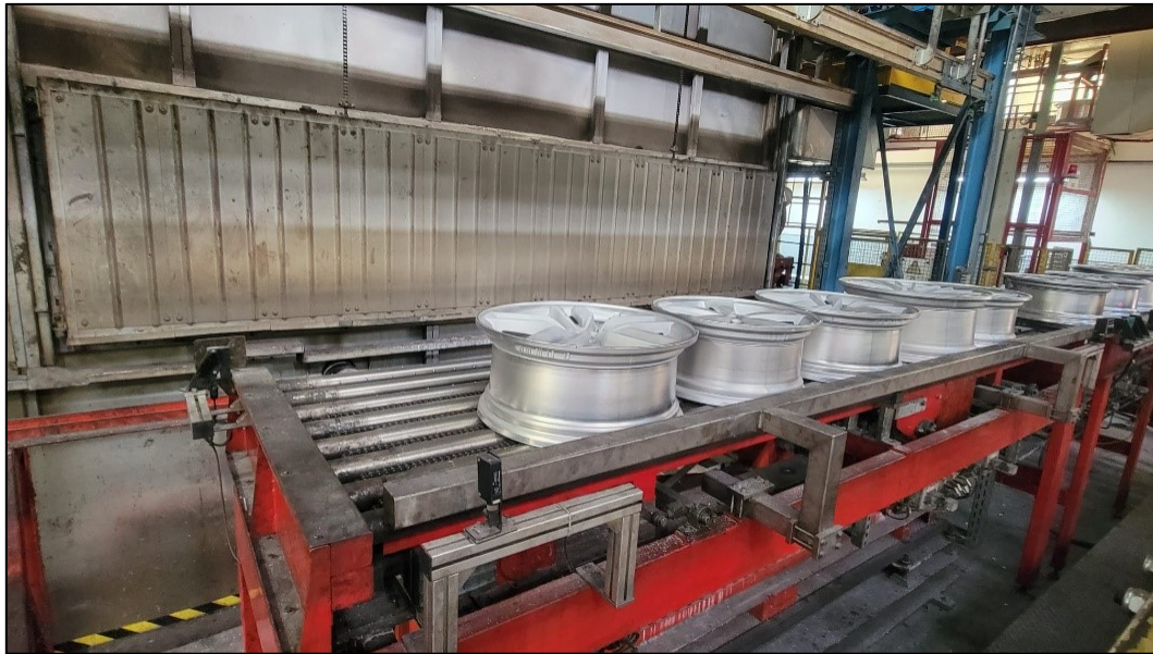
Fig. 3.4 – Rulliera di carico in entrata del forno di solubilizzazione
