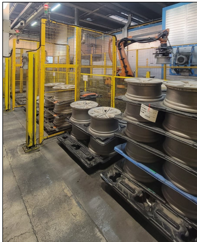
Fig. 3.7 – Baie di palletizzazione delle ruote trattate
