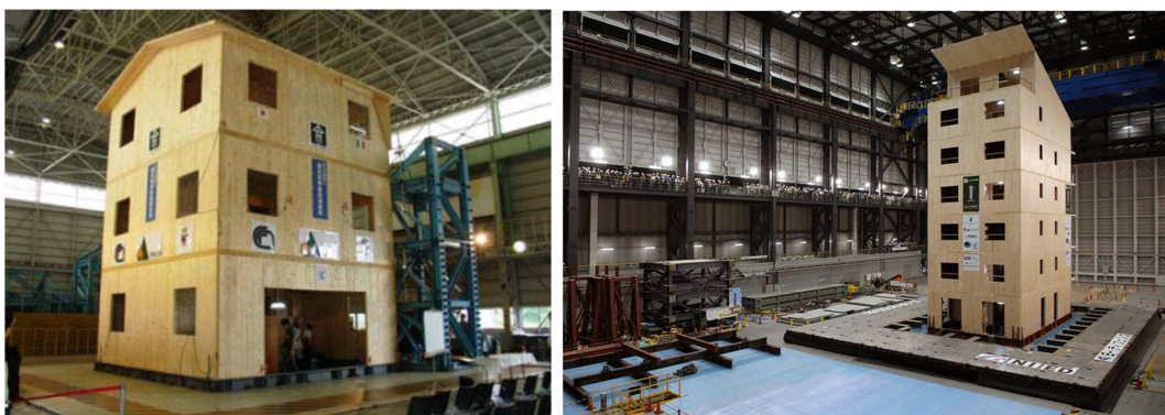
Fig. 1.4 Progetto SOFIE, prove su tavola vibrante di un edificio di 3 [7] piani e una di 7 piani [44]
