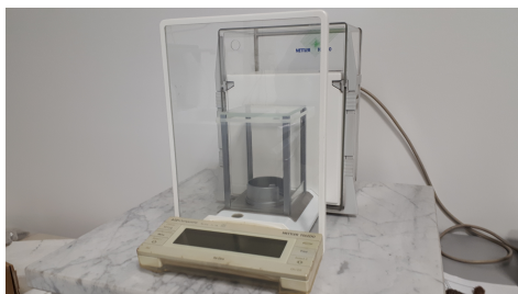
Figura 2.9: Bilancia di precisione utilizzata per pesare il materiale.
