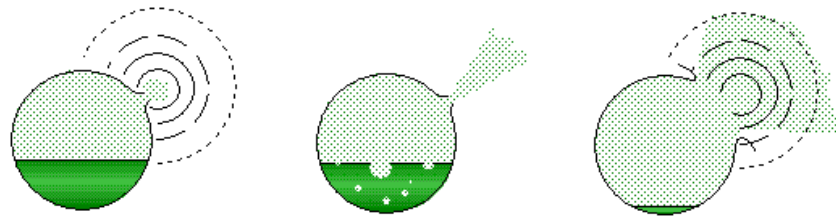
Figura 3.2-12 Rappresentazione semplificata di formazione di un BLEVE su un serbatoio cilindrico orizzontale a causa di un forte irraggiamento.
