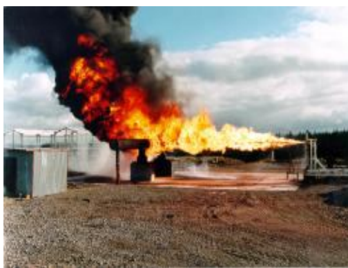
Figura 3.2-7 Esempio di Jet – Fire.
