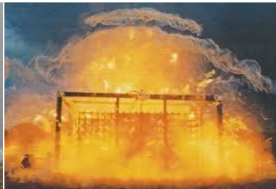
Figura 3.2-14 Esempio di UVCE.
