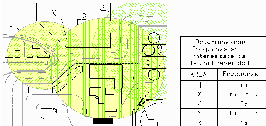
4.3-5 Rappresentazione delle aree interessate da lesioni reversibili con le rispettive frequenze di accadimento: la sovrapposizione parziale delle aree 1 e 2 porta alla formazione dell'area X mentre la sovrapposizione parziale delle aree 2 e 3 porta alla formazione dell'area Y. Le rispettive frequenze di accadimento di X ed Y sono date dalla somma delle frequenze delle aree che si sovrappongono (cioè 1 e 2 nel caso di X, 2 e 3 nel caso di Y).
