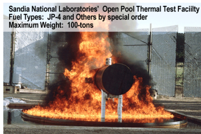
Figura 3.2-9 Pool fire generato da rilascio di materiale infiammabile all'interno del bacino di contenimento.
