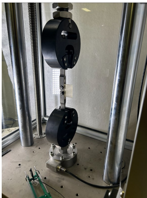
Figura 54: Provino CT posizionato con due supporti per la prova di frattura.
