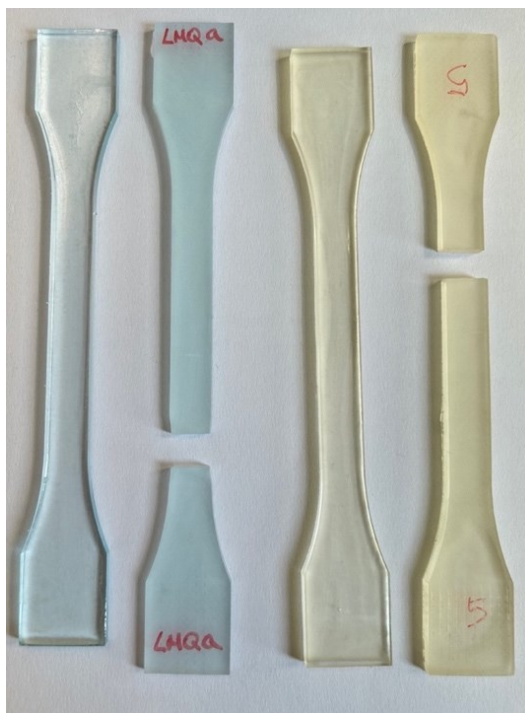
Figura 51: Provini DB delle resine EC157 e Epikote™ MGS prima e dopo la prova.
