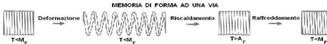
Fig. 2-8 . Effetto a memoria di forma ad una via in funzione della temperatura [10].
