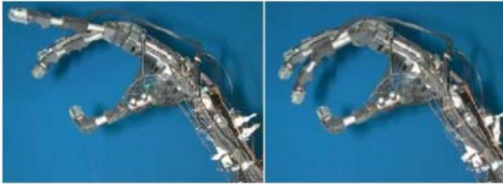
**Fig. 5-4 Mano robotica dimostrativa degli attuatori in EAP (Jet Propulsion Laboratory, JPL) [50].**
