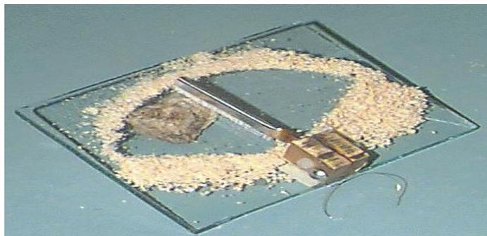
**Fig. 5-3 Prototipo del tergicristallo in EAP.**
