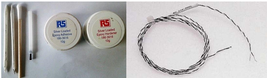
Figura 6.20: a destra gli utensili e la resina bicomponente usata per l'incollaggio delle termocoppie ( Epoxy Adhesive – Epoxy Hardener ); a sinistra il cavo rame-costantina della termocoppia.
