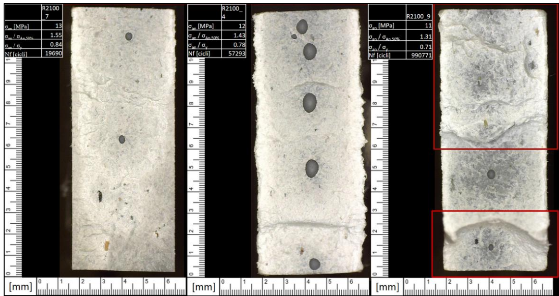
Figura 10.44: esempi di superfici di frattura di tre provini in R2100 testati. Sono riportati da sinistra verso destra a livelli di carico. Si evidenzia nel provino di destra la conformazione a diversi livelli di piano di rottura, che necessita una composizione di foto per la messa a fuoco completa della sezione.
