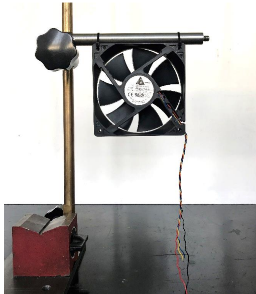
Figura 6.24: Ventola usata per forzare l'aria sul provino, con sistema di regolazione manuale. Viene collegata a un alimentatore a 12V o a 6V a seconda dell'esigenza.
