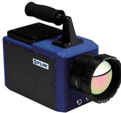
Figura 4.3: termo-camera FLIR SC7600 ad alte prestazioni.
