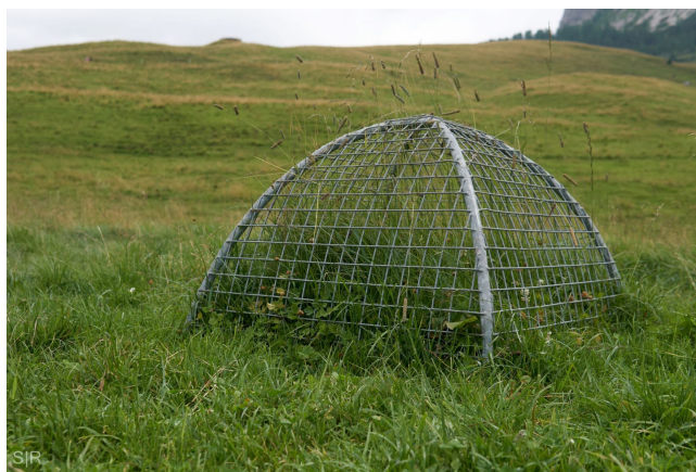
Figura 3.2: Fotografia di una gabbia di esclusione utilizzata per il campionamento.
