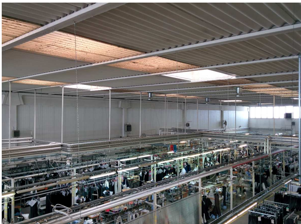
Figura 5.4 Vista dall'alto del reparto produttivo "cucito". Nell'ipotesi di progetto iniziale, la parete cieca sarebbe stata sfruttata come "aggancio" per i canali di ripresa dell'impianto di climatizzazione.
