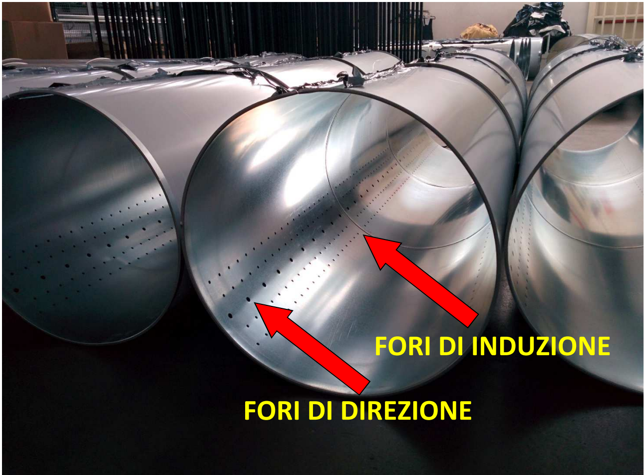
Figura 4.20 Particolare del tipo di foratura dei canali aerulici di mandata, a servizio dell'impianto di climatizzazione.
