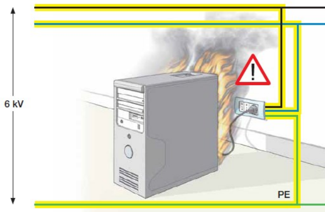
Fig. 1.2 – Effetto di una sovratensione da 6 kV in assenza di protezione: il dispositivo viene distrutto.
