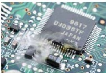
Fig. 6.3 – Danneggiamento di una scheda a circuito stampato (PCB) in seguito ad un transitorio di tensione.
