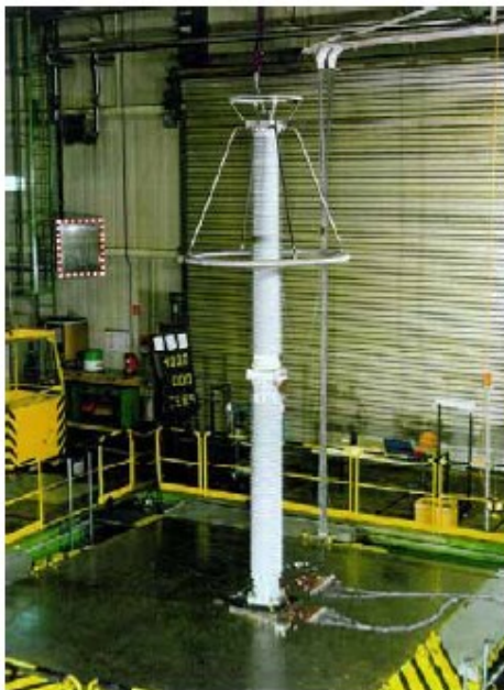
Fig. 7.9 – Scaricatore in polimeri per un sistema a 550 kV, durante una prova sismica su tavola vibrante.
