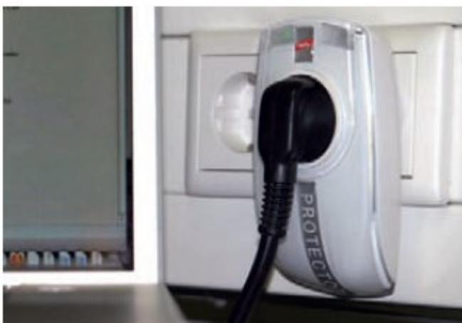
Fig. 6.9 – Dispositivo di protezione universale contro le sovratensioni per la protezione delle linee di rete e delle linee dati (in figura un esempio di un prodotto del catalogo di Dehn, DEHNprotector).
