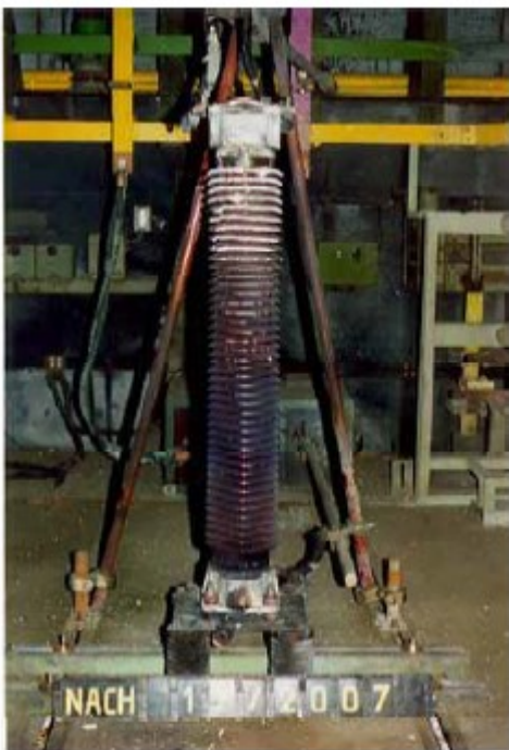
Fig. 7.10 – Scaricatore in porcellana dopo un test ad una corrente di cortocircuito nominale di 63 kA (durata di 200 ms). L'alloggiamento è rimasto pressoché intatto.
