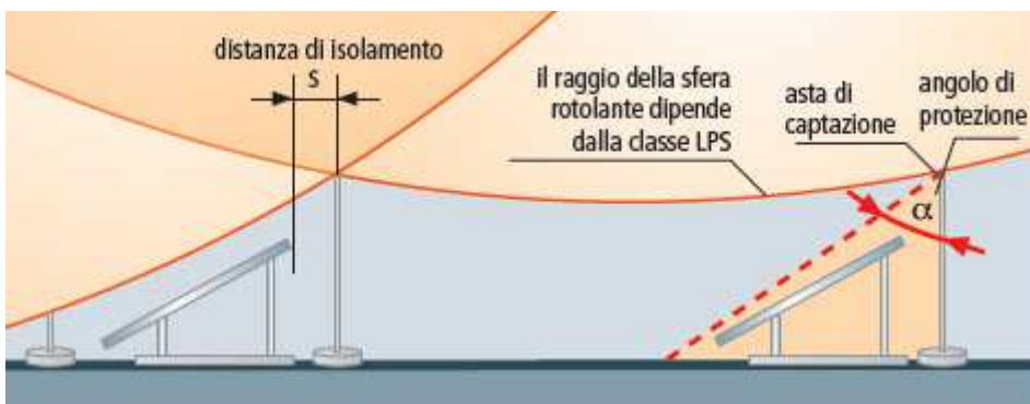
Fig. 5.6 – Confronto tra il metodo dell'angolo di protezione e il metodo della sfera rotolante per la determinazione del volume protetto.
