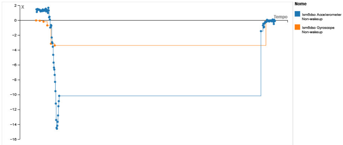
Figura 13: registrazione dati sensori con il dispositivo che va in ambient mode
