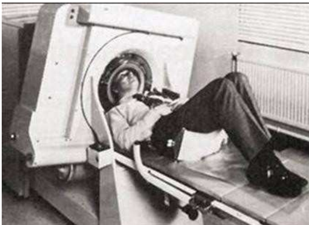
Figura 1. Il primo tomografo computerizzato per lo studio del cranio prodotto nel 1973 dalla EMI. Immagine tratta da "Elementi di tomografia computerizzata" di Faggioni L.
