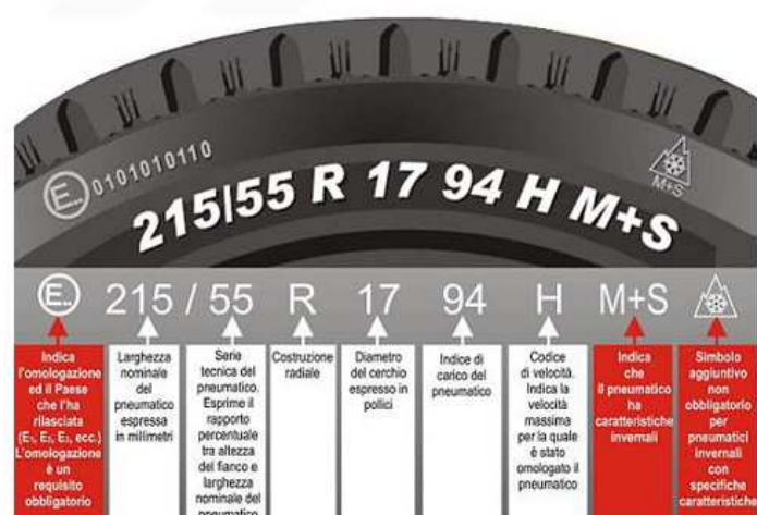
Fig. 5.10 – Schematizzazione riguardante la lettura del pneumatico (www.pneusmarca.com)
