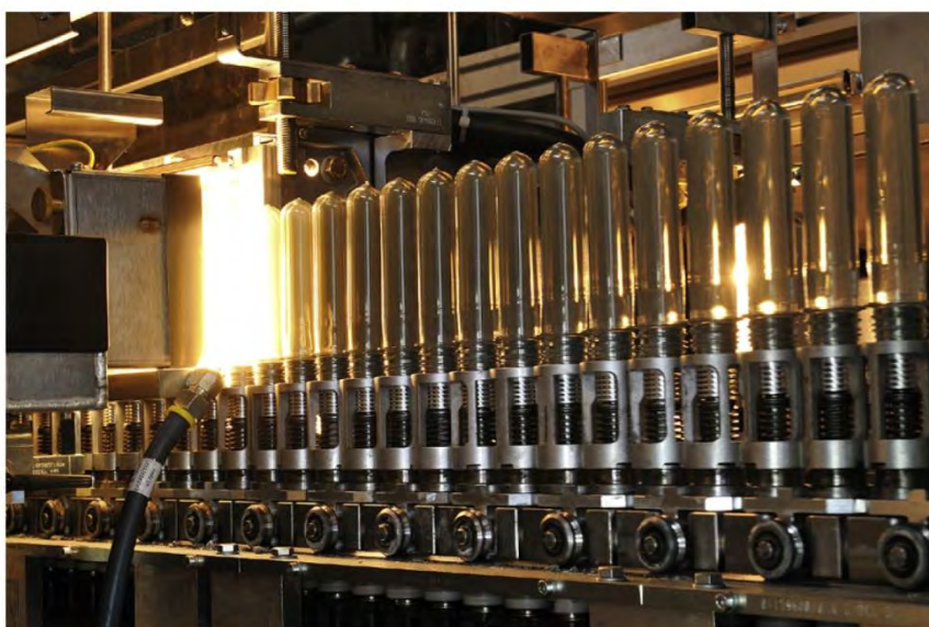
Figura 4.8: Preforme riscaldate in un forno ad infrarossi. Fonte: Sidel Inc.
