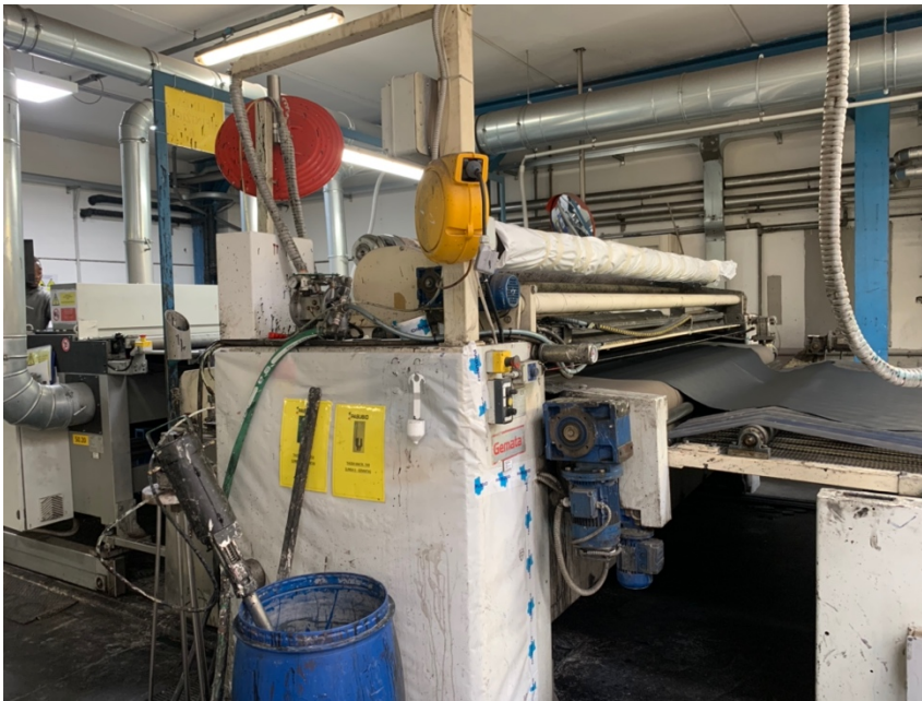
Figura 8. Macchina che serve a stuccare la pelle eliminando le imperfezioni come ad esempio buchi, ed è utilizzata prima della fase di rifinitura per le pelli superiori alla prima e seconda scelta quindi di terza e quarta e via dicendo.
