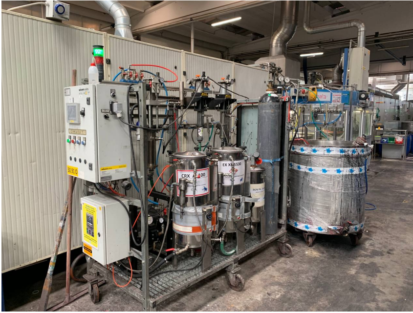
Figura 5. Strumento per pompaggio: pompa che determina la pressione e la grammatura del fissativo che viene spruzzato a seconda della ricetta utilizzata.
