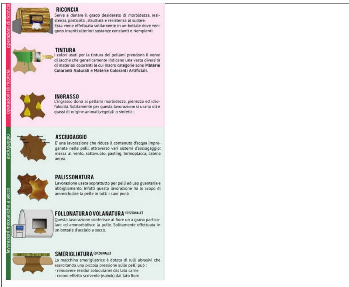
Figura 13. Terza parte infografica del processo di lavorazione della pelle e del cuoio.
