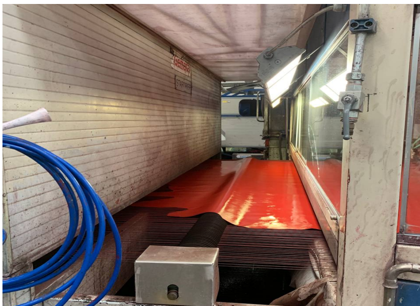
Figura 3. Pelle bagnata prima di entrare nel forno a 80-100 gradi (2/3 forni circa) per prima asciugatura ed assorbimento del colore sulla pelle. Strumento utilizzato Todesco (metodo spray coating).
