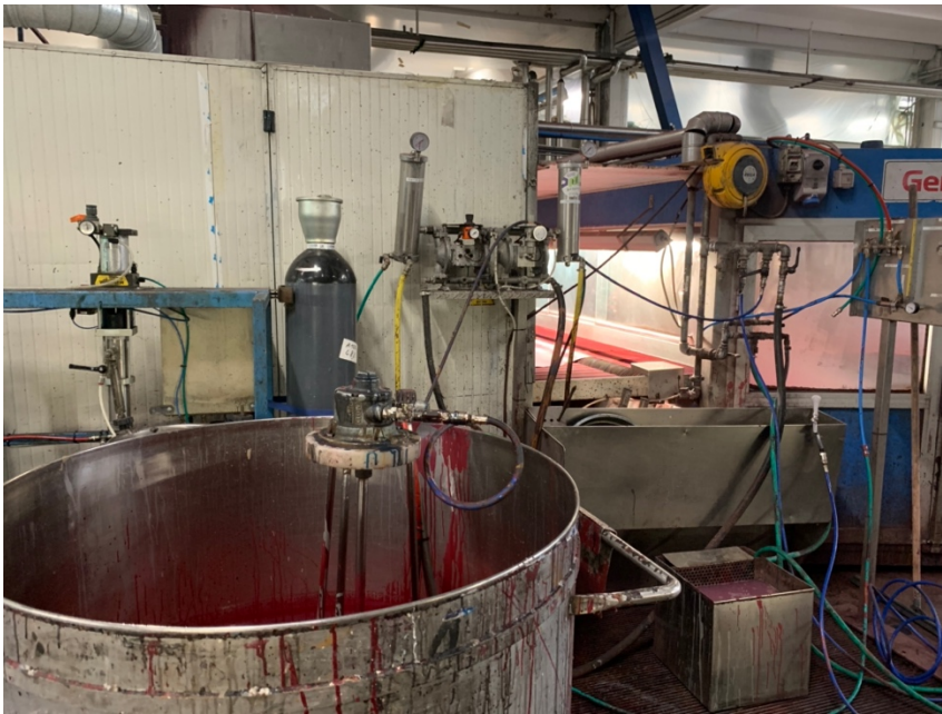
Figura 2. Botte con colorazione rossa per la fase di tintura. Il colore viene pompato attraverso un macchinario di pompaggio. La tecnica per la colorazione è a spray circolare: nella prima parte spruzza il colore che creerà delle linee circolari che verranno riempite nella seconda parte prima di entrare nel forno ed avere il prodotto tinto. Strumento utilizzato Gemata.
